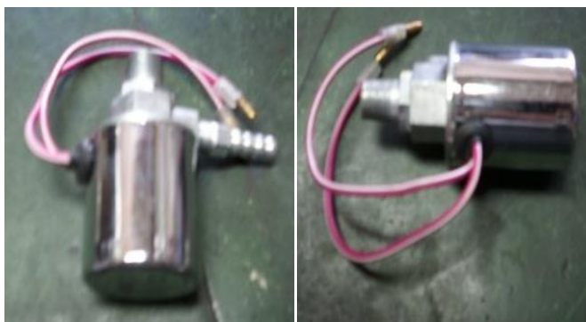
Fig. 33 Electroválvula de 12V
