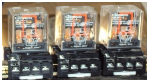
Fig. 30 Relés de 11 pines CAMSCO
