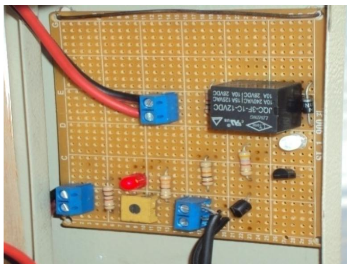
Fig. 39 Circuito electrónico que controla el encendido y apagado del sistema de aireación mediante una resistencia de luz
