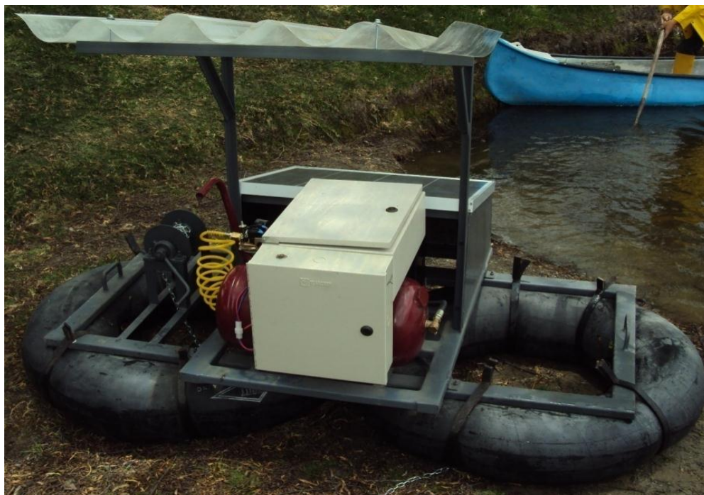
Fig. 38 Sistema de oxigenación de agua mediante energía solar
