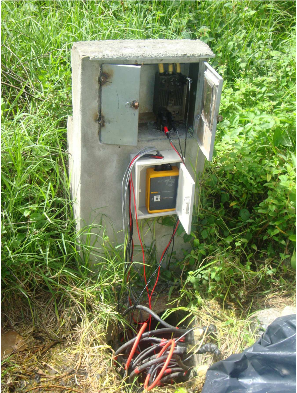
Instalación Fluke 1743 nodo principal
