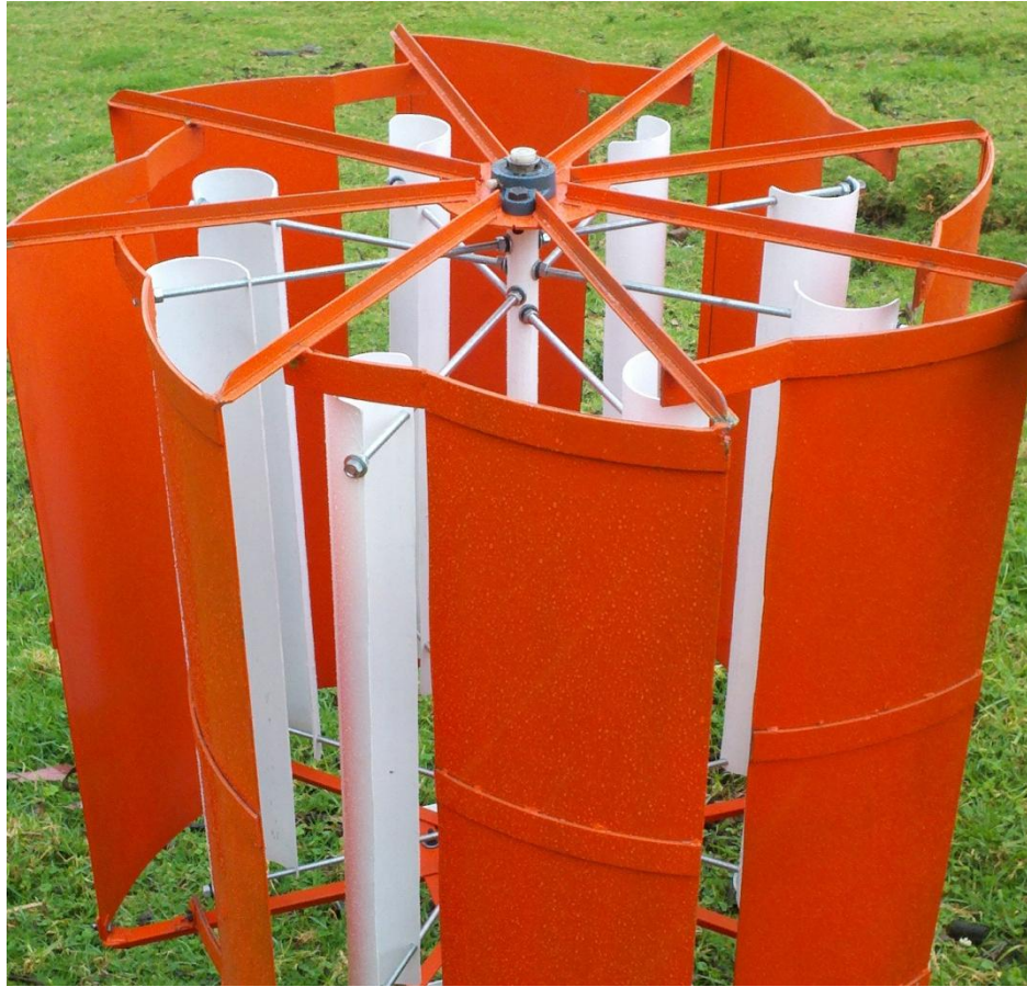
Figura 55. Carcasa de direccionadores armada en conjunto con el rotor.
