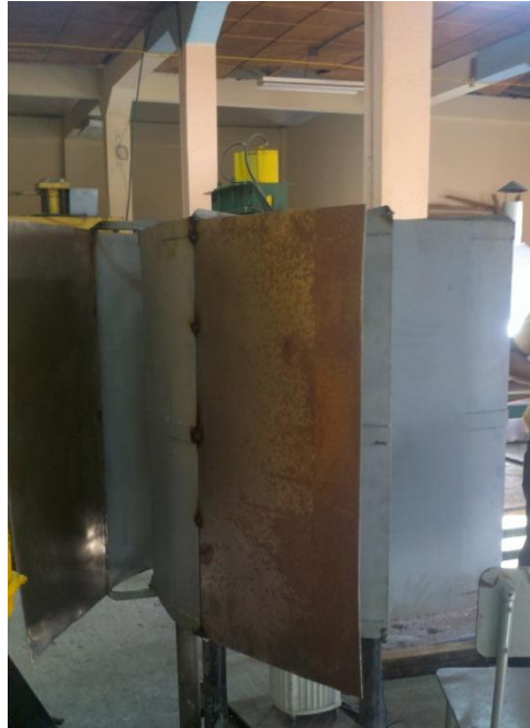
Figura 47. Rotor savonius de fibra de vidrio con prolongaciones de entrada en la tobera.
