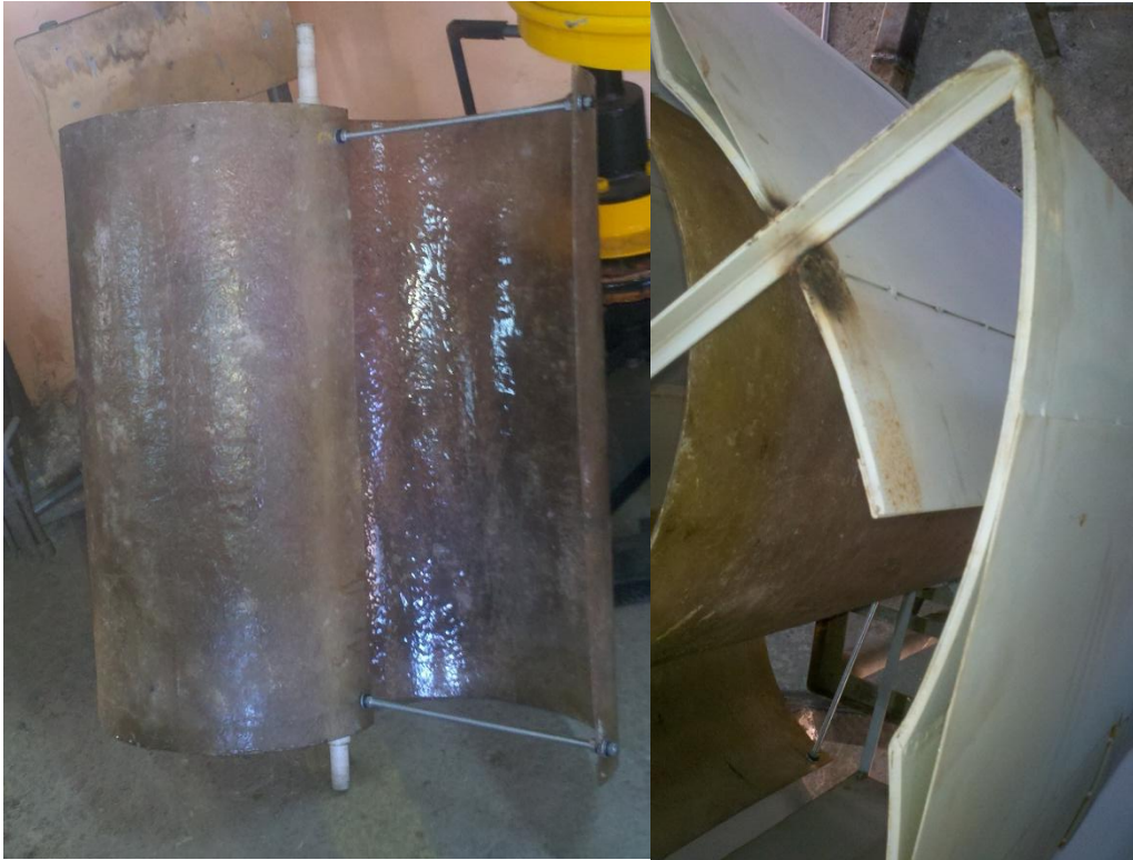
Figura 44. Rotor savonius construido en fibra de vidrio cubierto por la carcasa de toberas.
