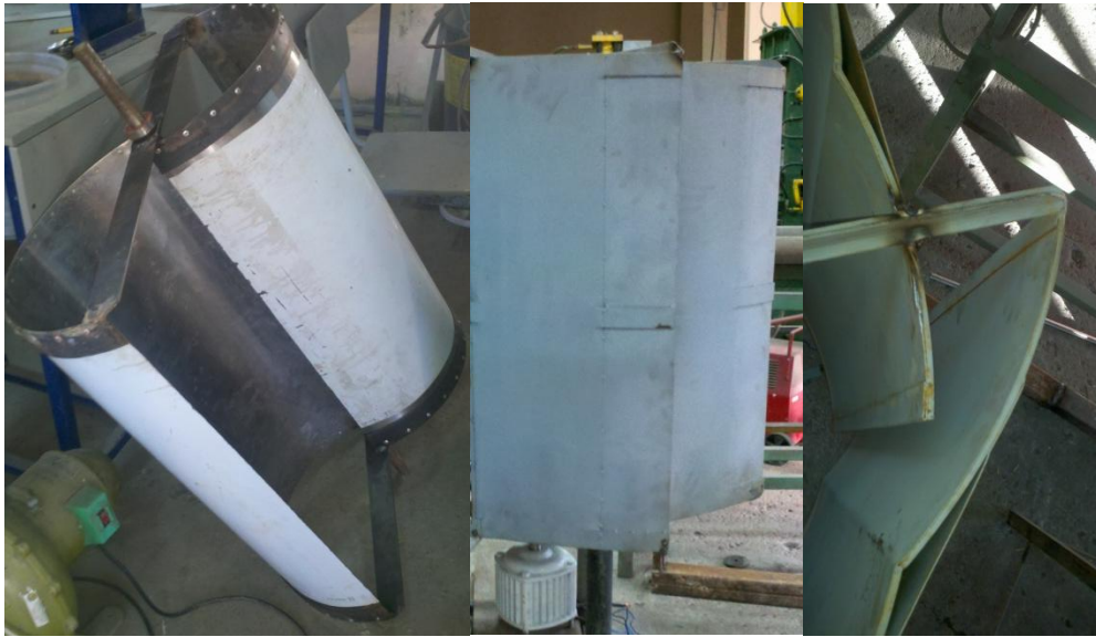
Figura 43. Rotor savonius de acero inoxidable con carcasa de toberas.
