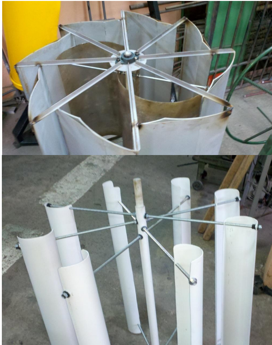
Figura 50. Carcasa con aumento de área de salida en las toberas, y rotor multipala de ocho cazoletas
