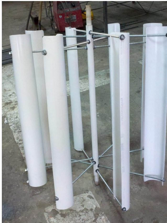
Figura 54. Rotor de ocho cazoletas armado
