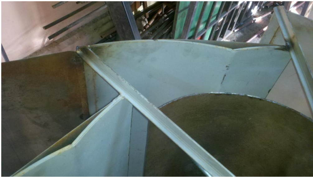
Figura 48. Rotor savonius de fibra de vidrio con aumento de área de entrada y de salida en la tobera
