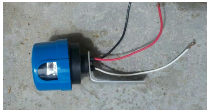
Figura 60. Interruptor automático con fotocelda
