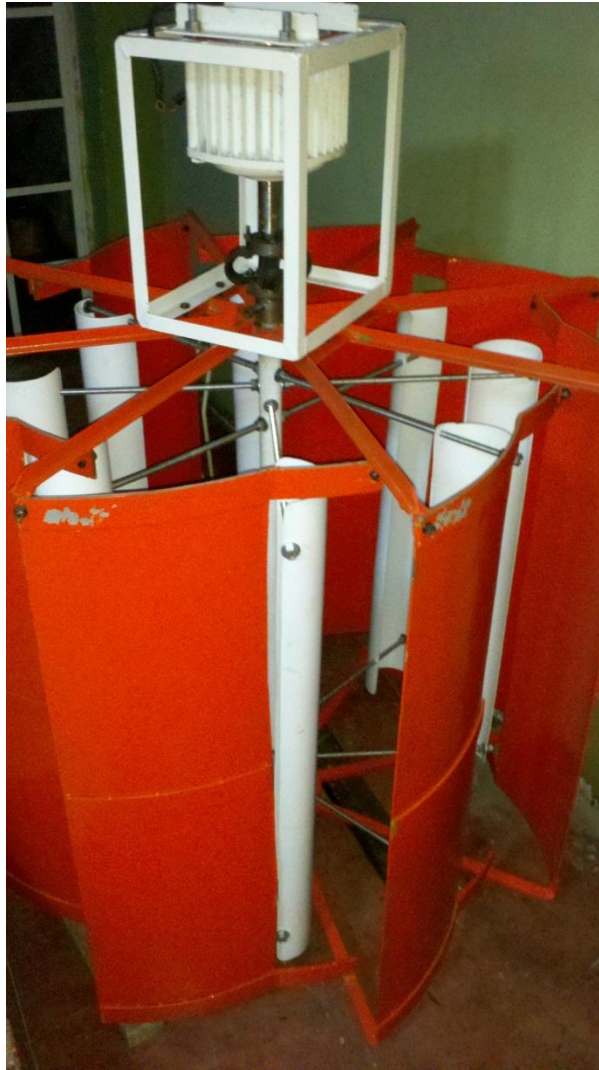
Figura 56. Carcasa de generador y generador armado y fijado a la base de la carcasa de direccionadores.
