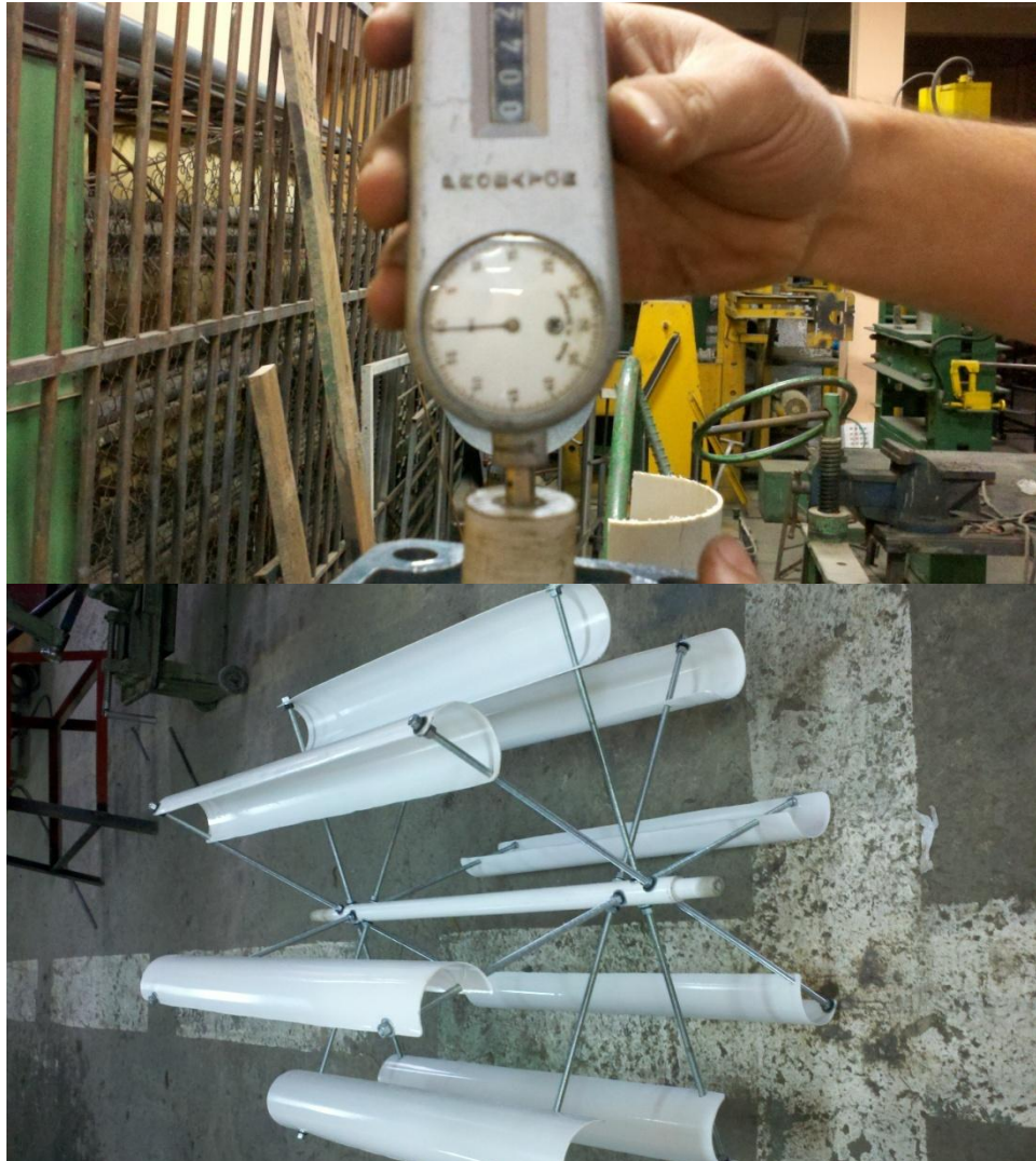
Figura 53. Prueba de rotor multipala de ocho cazoletas sin carcasa de direccionadores
