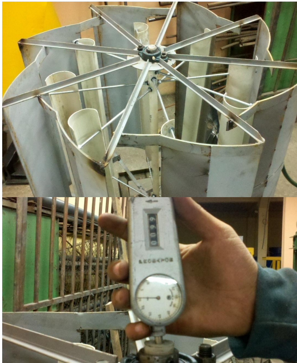
Figura 52. Máximas revoluciones obtenidas con el rotor multipala de ocho cazoletas y carcasa de direccionadores con gran área de admisión de viento.
