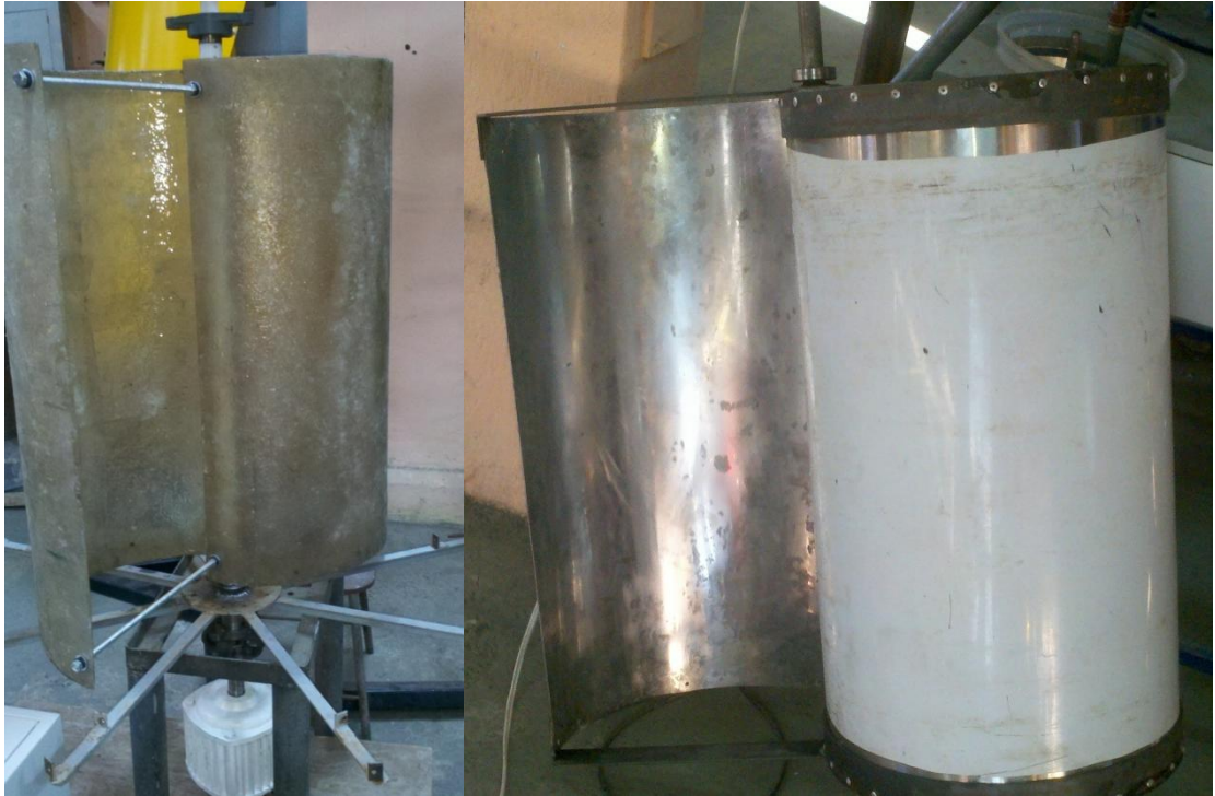
Figura 45. Rotor savonius de acero inoxidable y de fibra de vidrio sin carcasa de toberas
