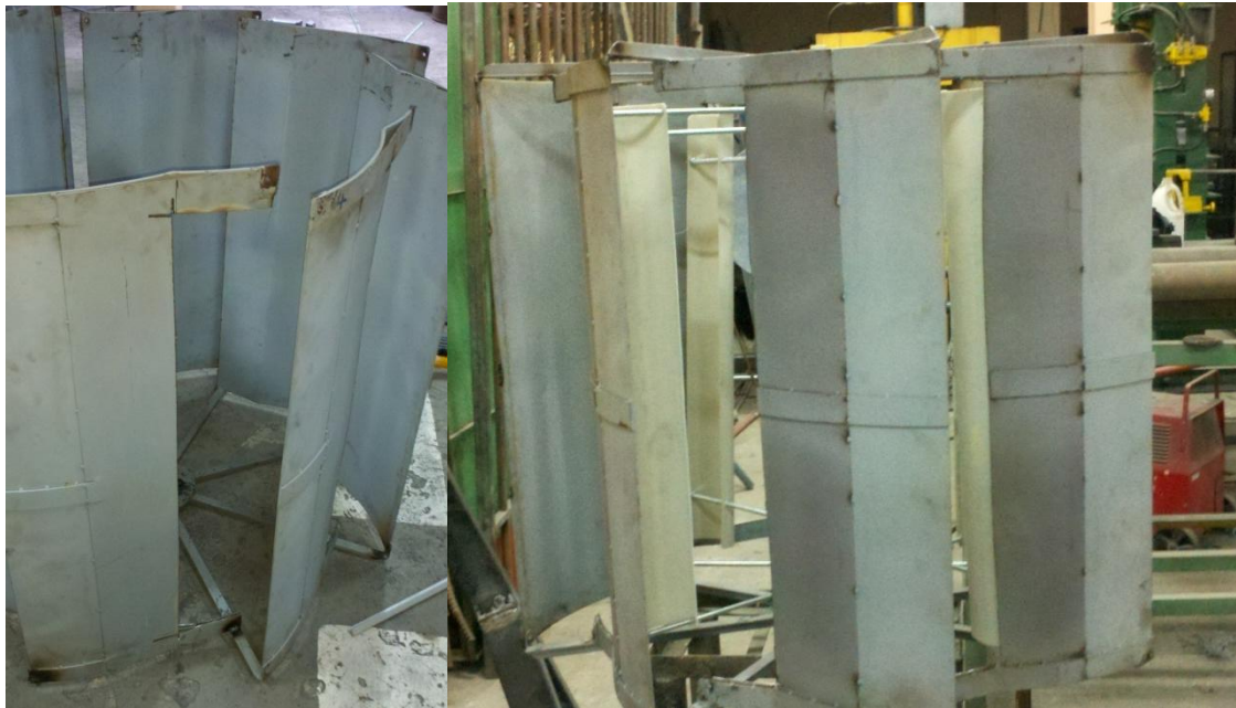
Figura 51. Aumento de área de admisión de aire quedando únicamente el sistema de direccionamiento de viento.
