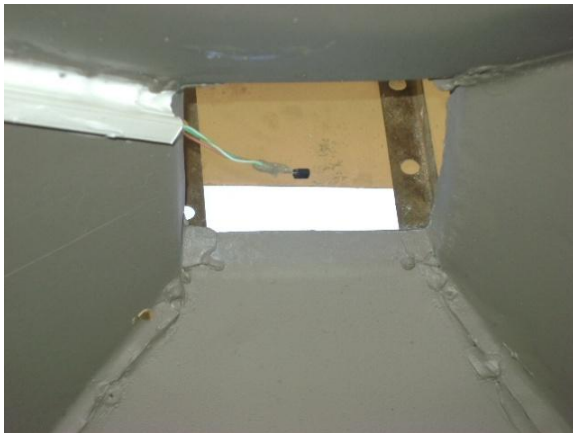
Sensor de temperatura LM35 a la salida
