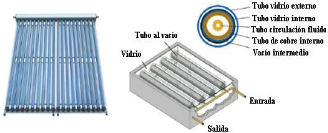
Fig. 10: Colector solar de tubos de vacío y sus componentes
