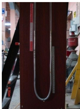
Figura 30.- Manómetro construido para poder determinar, de ser posible con exactitud, el valor de Kv para la válvula en la impulsión del sistema.
