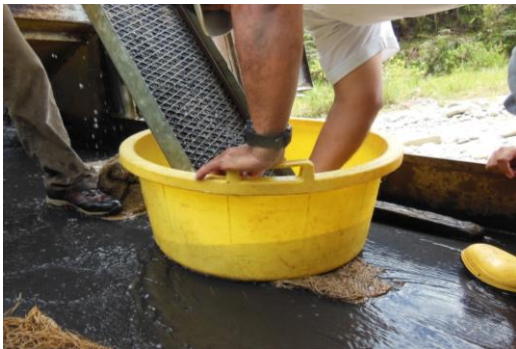
Concentrado de mineral en una matraca.
