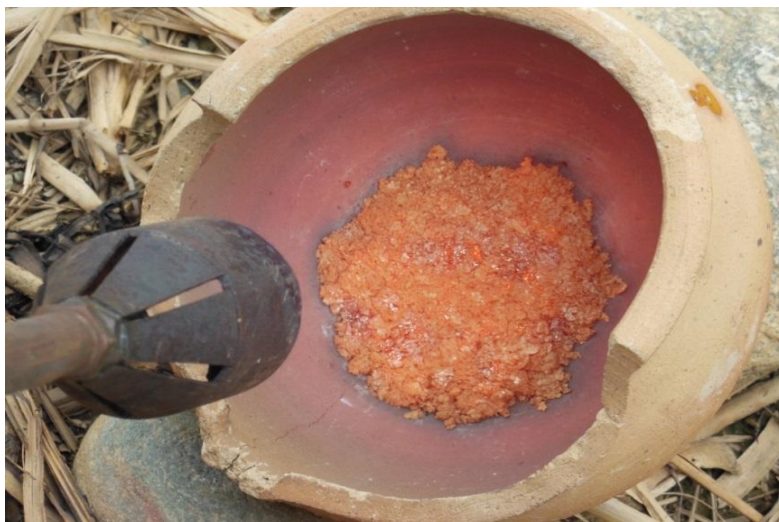
Figura 15. Quema de amalgama en el cantón Yacuambi.
