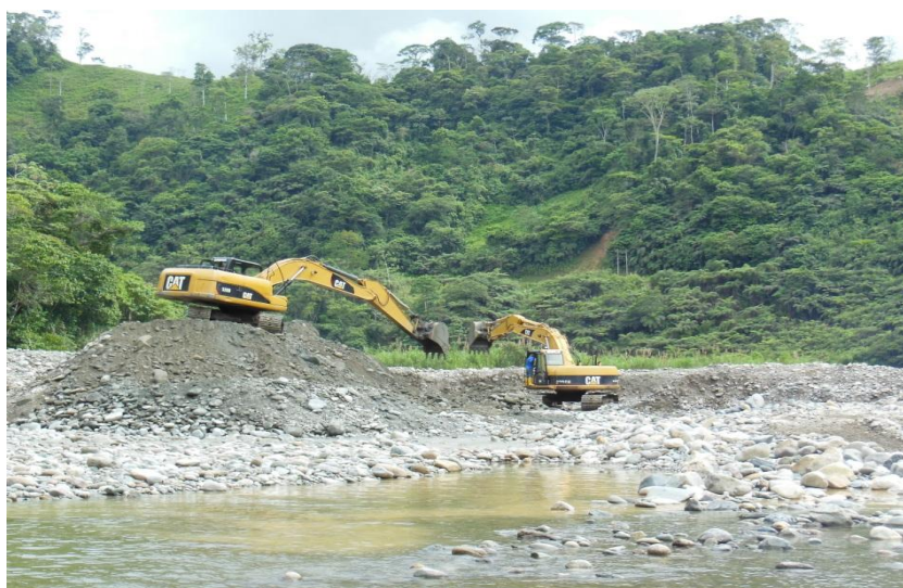
Figura 10. Extracción de grava aurífera a través de excavadoras en el cantón Yacuambi.
