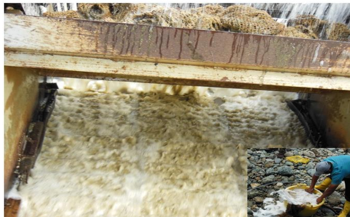
Figura 13. Lavado de sacos de yute y recuperación de concentrado en el cantón Yacuambi.
