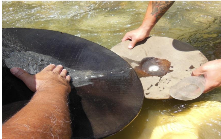
Figura 14. Recuperación de oro a través del uso de platón y formación de amalgama en el cantón Yacuambi
