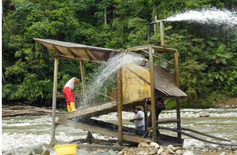
Figura 11. Concentrador gravimétrico tipo Z utilizado en el cantón Yacuambi.
