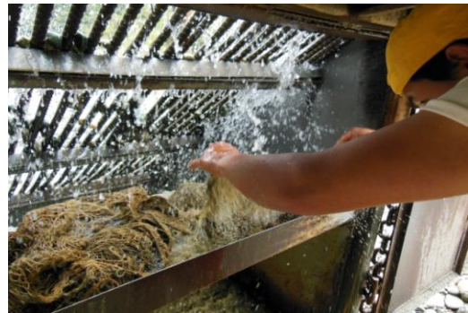
Lavado de sacos de yute para recuperación de concentrado de mineral.
