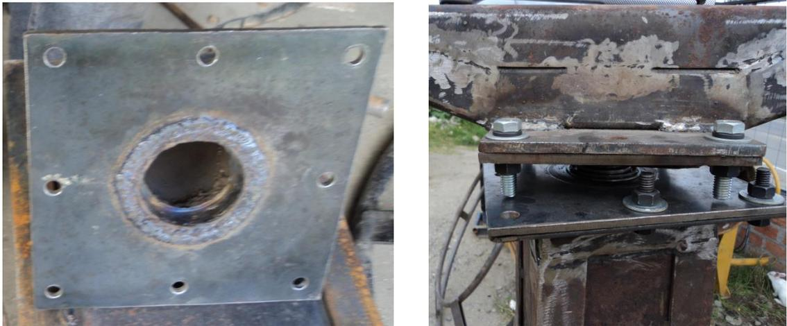
*Fig. 4.1: Mecanizado y soldadura del tubo de vapor para pista de rodamiento cónico, acoplamiento y montaje del eje vertical y brazo respectivamente. (FUENTE – Autores, 2010)*
