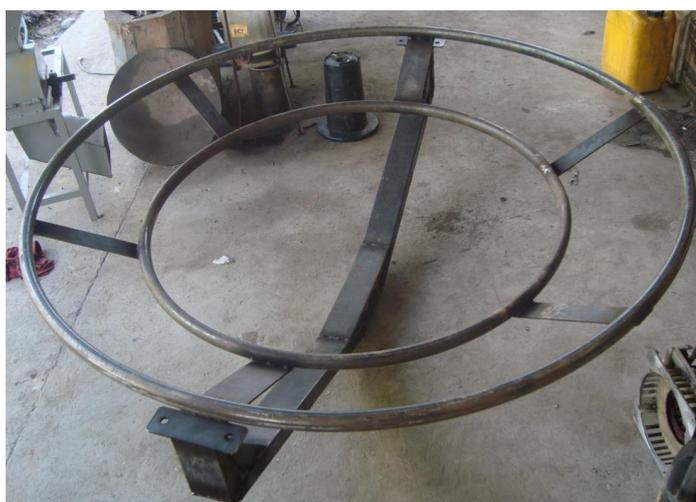
Fig. 4.15: Aros soldados por platinas para soporte de la parábola. (FUENTE – Autores, 2010)
