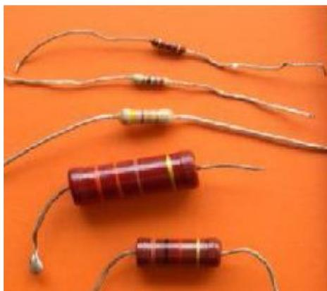
Figura 3.21: Bandas de colores en las resistencias. (FUENTE – Foto, 2011)
