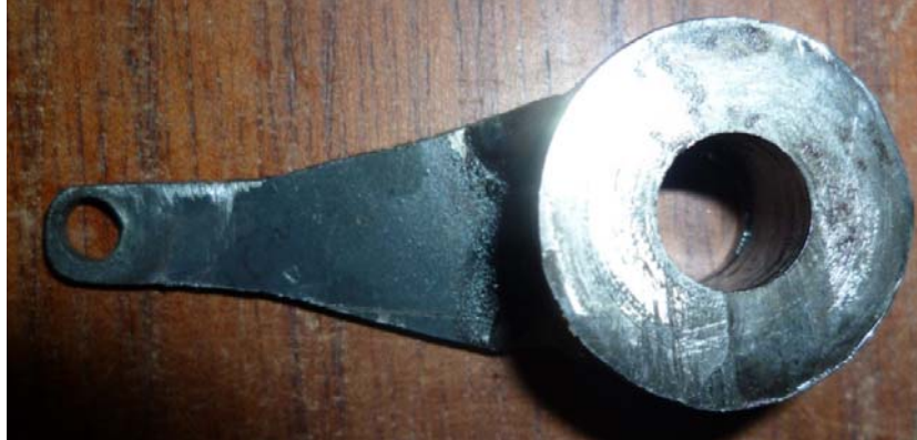
Figura 51. Biela del desplazador.
