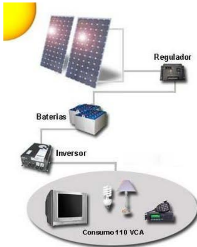
Figura 6. Elementos adicionales de una instalación fotovoltaica.
