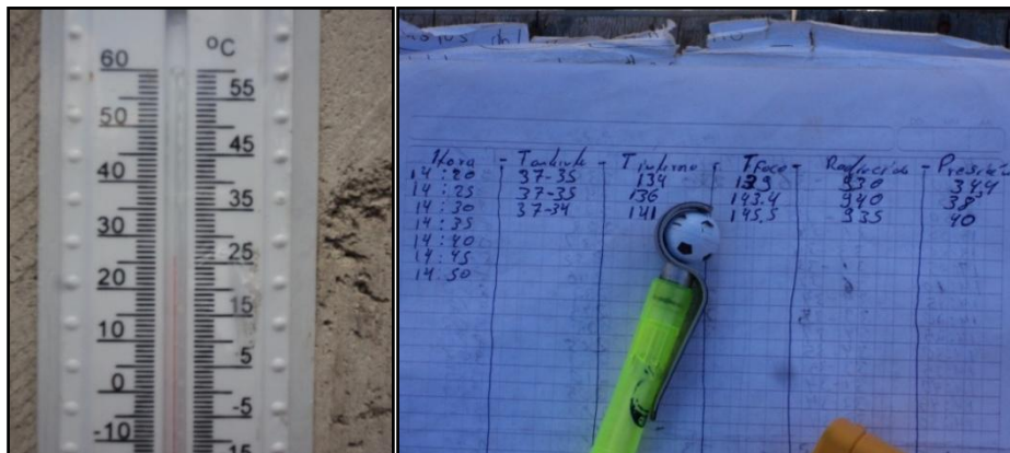
Fig. 23. Medición de la temperatura ambiente y hoja de datos del monitoreo.
