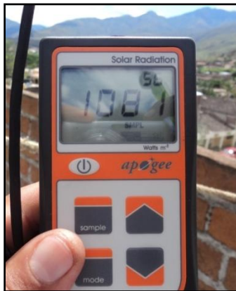
Fig. 22. Medición de la radiación solar global.
