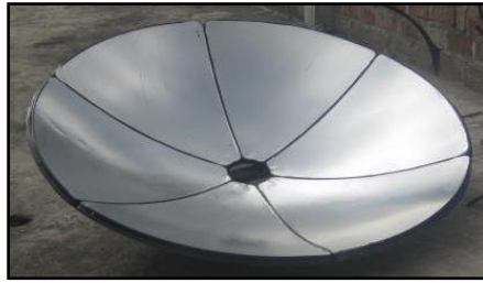
Fig. 114. Sistema de concentración y reflexión completa.
