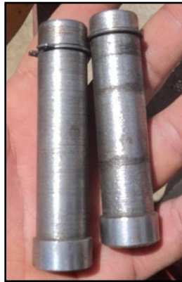
Fig. 98. Ejes para el movimiento acimutal.
