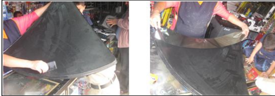
Fig. 1. Colocación de la película de aluminio sobre el concentrador.
