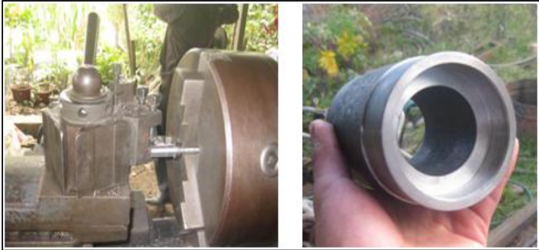
Fig. 7. Torneado de la caja de rodamientos.
