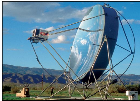
Fig. 14. Esquema de un sistema Disco-Parabólico (Disco-Stirling).
