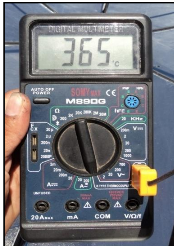
Fig. 28. Temperatura máxima alcanzada en el plano focal (receptor tipo cavidad).
