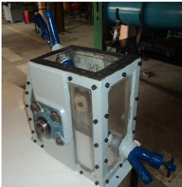
Montaje de los inyectores.
