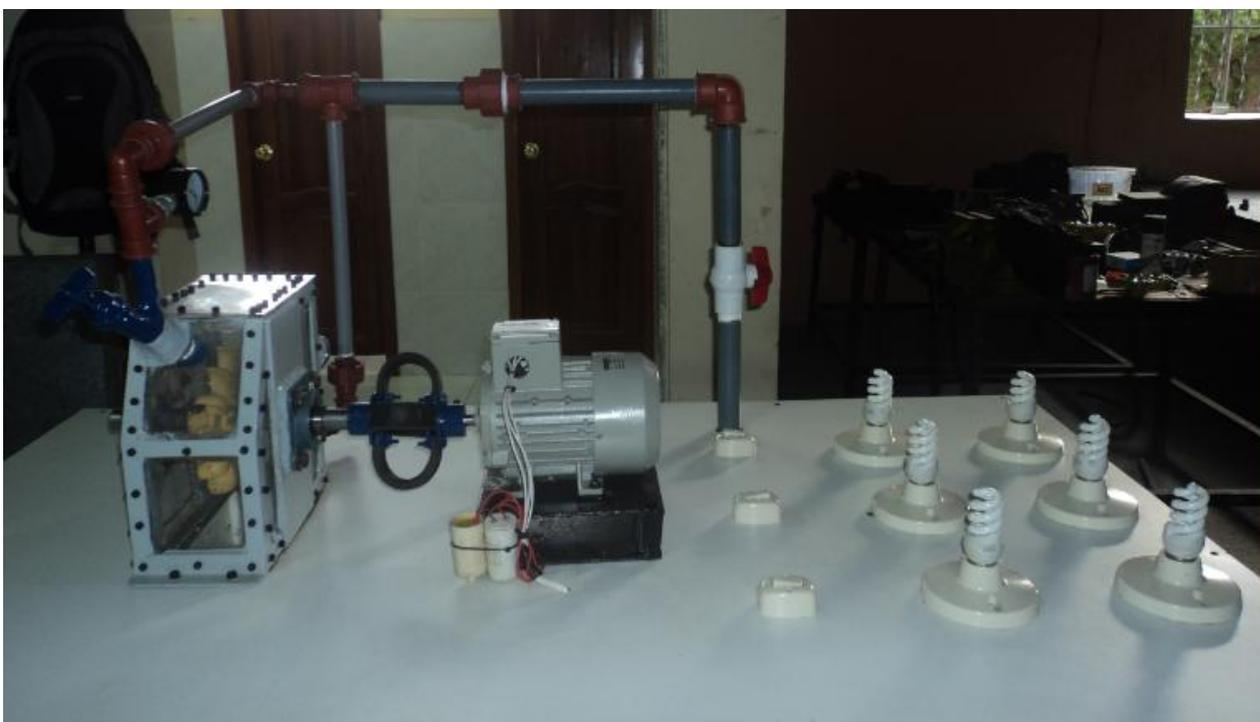
Vista superior del prototipo de la pico central hidráulica.
