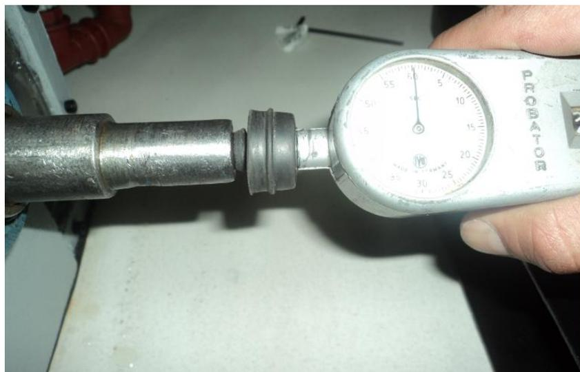
Medición de las revoluciones con el tacómetro.
