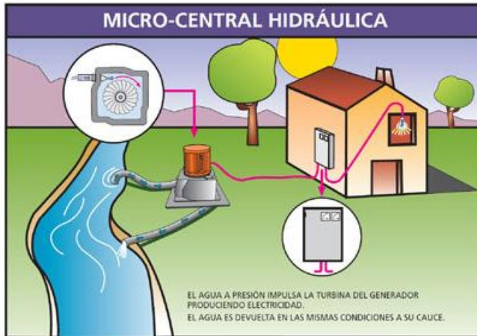
Fig. 1.2. Esquema de una pico central hidroeléctrica
