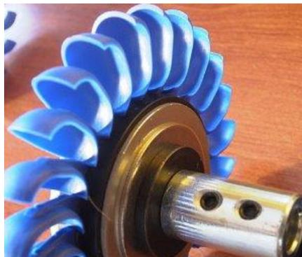
Fig. 1.3. Turbina Hidráulica Turgo
