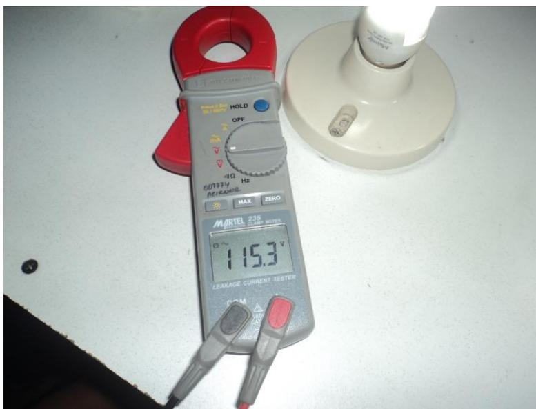
Medición del voltaje con el multímetro digital
