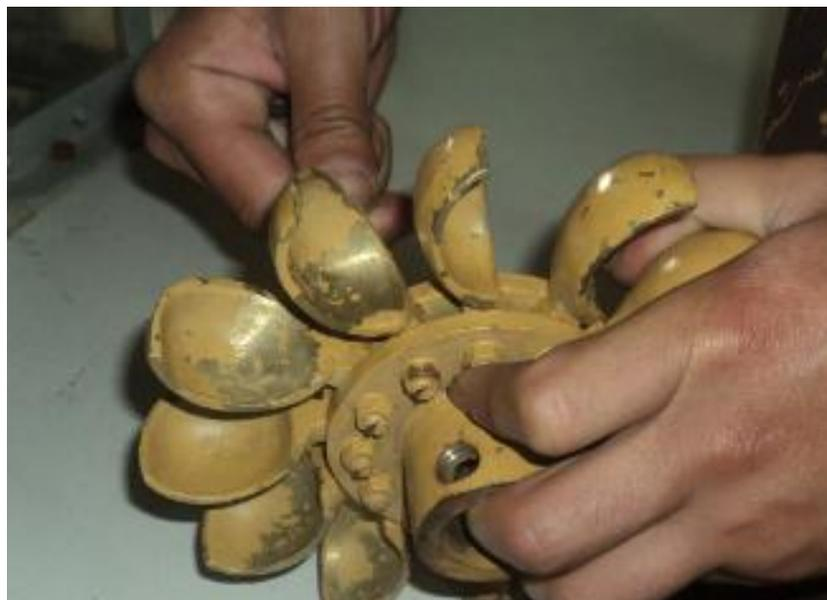
Fig. 2.4. Montaje de los álabes en los discos
