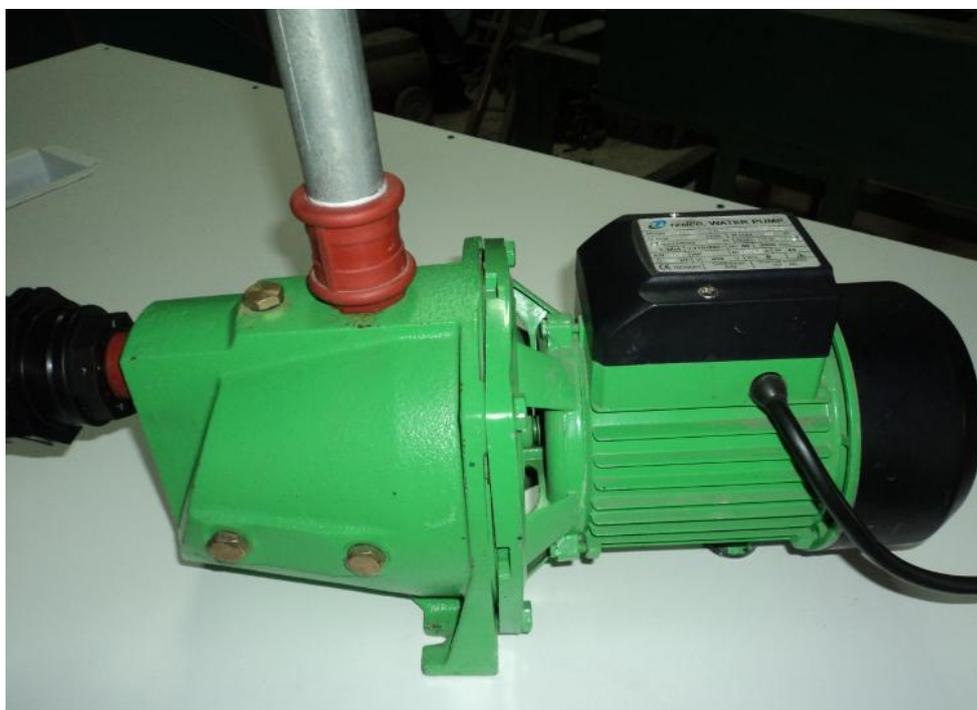
Fig.3.2. Bomba centrifuga JSW/10H alimentada por un motor monofásico de 1hp y velocidad nominal de 3450 rpm.
