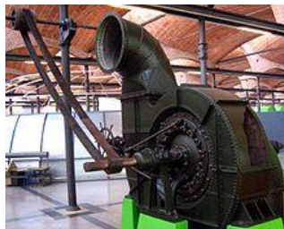
Fig. 15. Primitiva turbina Francis
