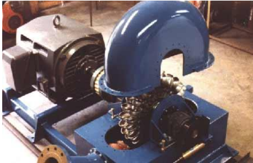
Fig. 8. Conjunto de una turbina Pelton.
