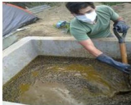
Una vez concluida con la alimentación del reactor con la mezcla estiércol-agua mediante relación en kg., de 1:2.5 respectivamente, nos queda por esperar la producción del biogás.
