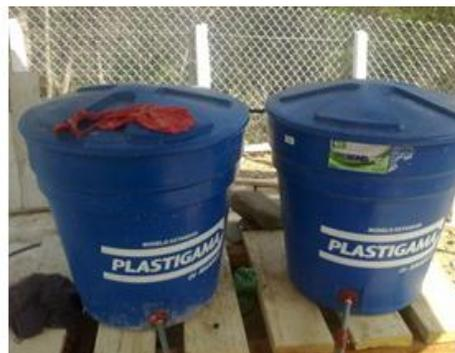
Una vez instalada los equipos y materiales de la planta productora de biogás realizamos unas pruebas de hermeticidad, con ayuda de un compresor, jabón en polvo y cámara de humo, esto con el propósito de evitar posibles fugas en el reactor.
