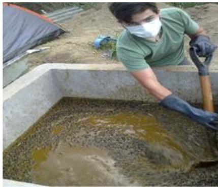
Una vez concluida con la alimentación del reactor con la mezcla estiércol-agua mediante relación en kg., de 1:2.5 respectivamente, nos queda por esperar la producción del biogás.
