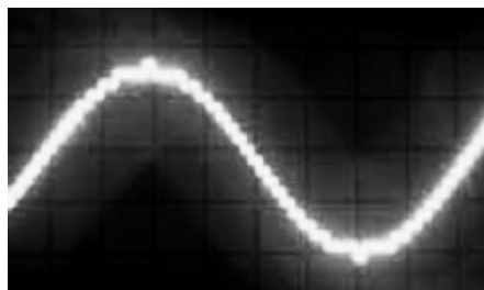
Figura 18. Tensión de salida de un inversor de onda sinusoidal modificada.
