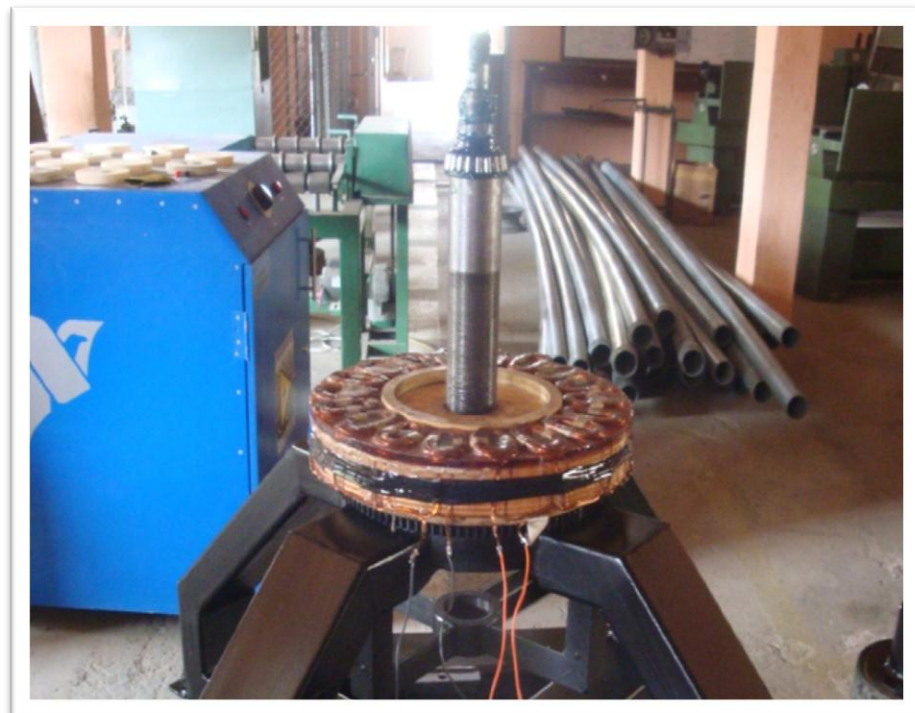
Figura 3.21: Conjunto ensamblado sin el rotor.
