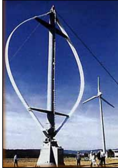
Figura 1.36: Darrieus de 5m. de diámetro
