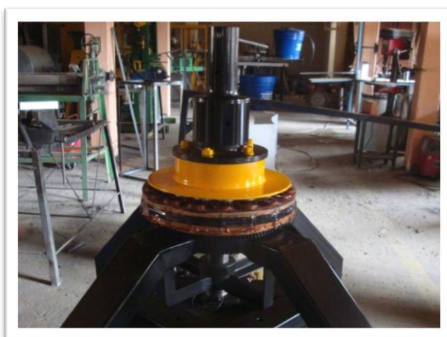
Figura 3.9: Generador de Imanes Permanentes.
