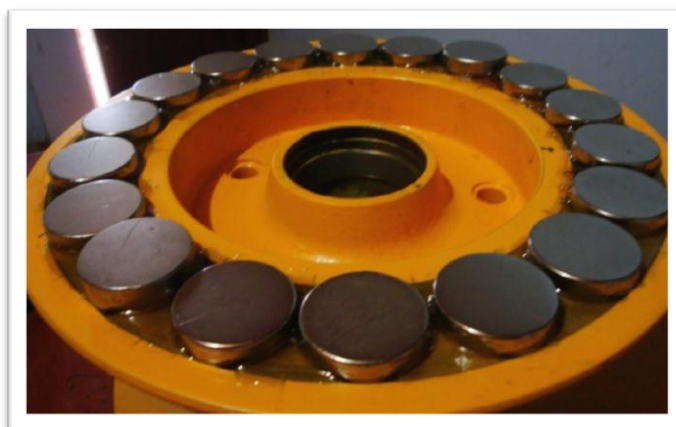
Figura 3.19: Imanes pegados al disco de freno
