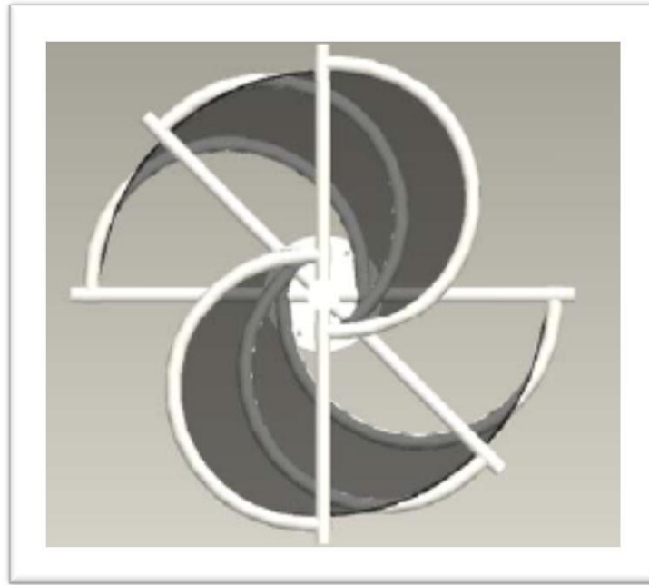
Figura 3.3: Vista superior del aerogenerador.
