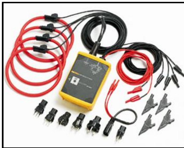
Figura 2. Analizador de redes FLUKE 1744
