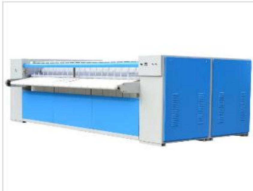
Figura 63: Rodillo planchador a vapor.
