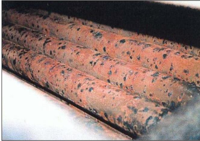
Figura 15: Corrosión por oxígeno o “pitting”
