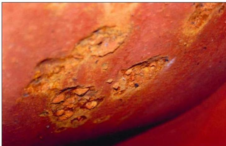
Figura 16: Corrosión cáustica en fogón de una caldera.
