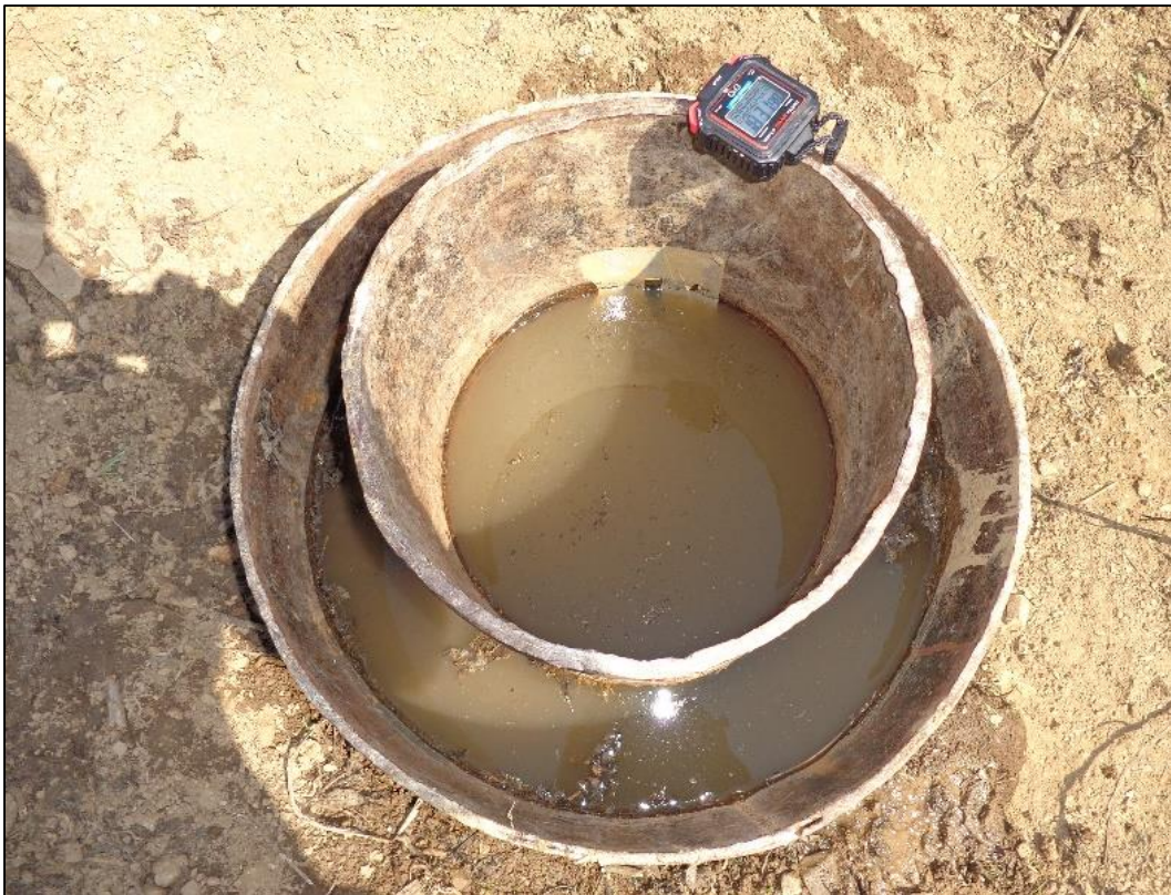
Figura 20. Prueba de infiltración con anillos infiltrómetros
