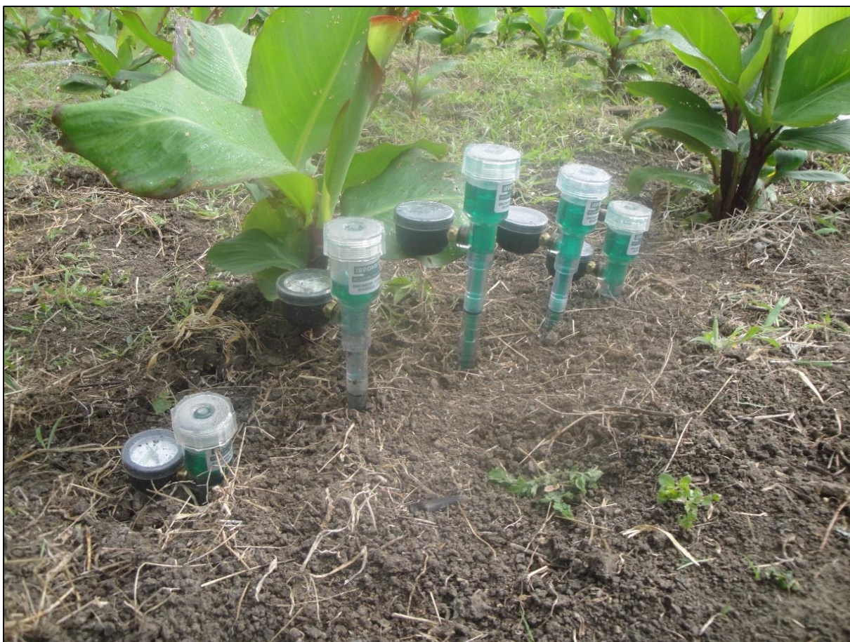
Figura 49. Ubicación de tensiómetros a diferentes profundidades para determinar el tiempo de reducción de lecturas a 4 centibares.
