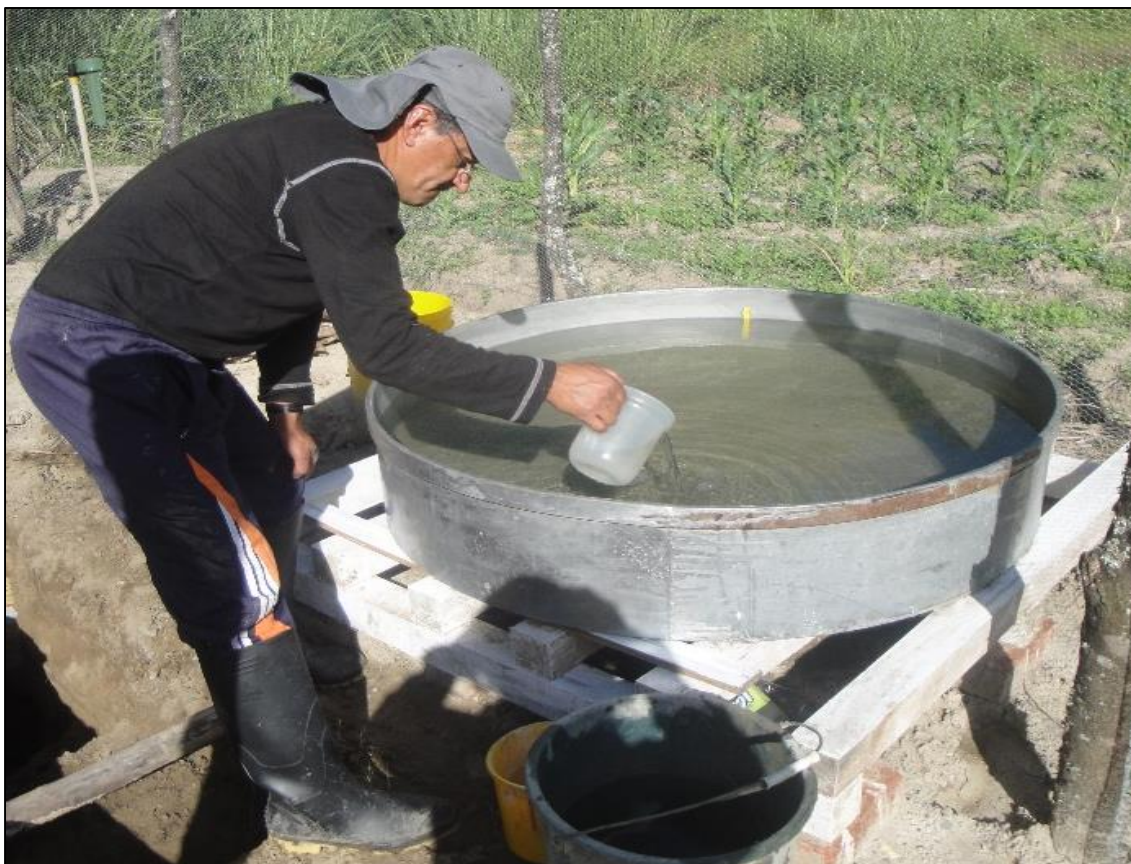
Figura 18. Tanque evaporímetro clase A en el área de ensayo
