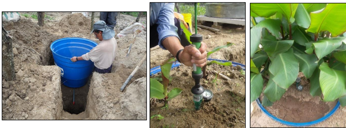
Figura 45. Instalación del lisímetro y su mantenimiento.
