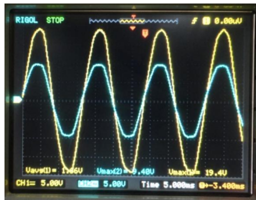
Figura 110. Medición de voltaje AC, antes y después del transformador, con osciloscopio.
