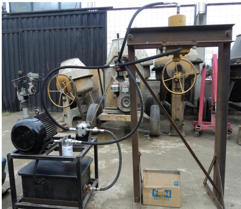
Conexiones de las mangueras de la red hidráulica.
