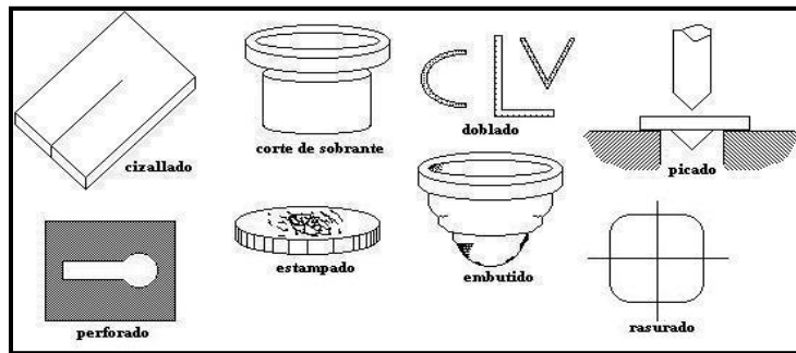
Fig. 1: Operaciones que se realizan con un troquel.
