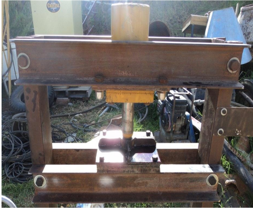
Ajuste de la las matrices en la máquina.
