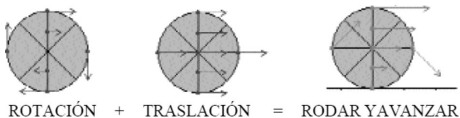
Fig.13: Demostración gráfica de los movimientos de rotación y traslación en una rueda
