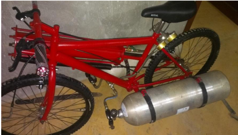
Fig 37: Bicicleta con motor de aire terminado
