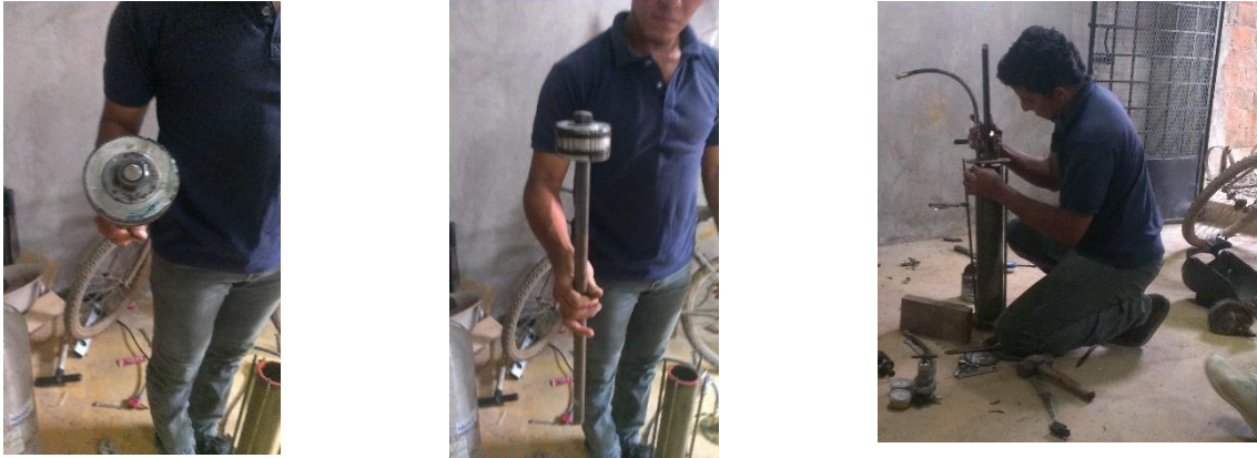
Fig 33: Pistón y armado del cilindro
