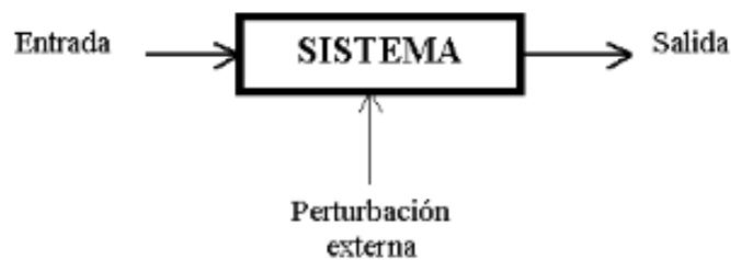
Figura 2. Sistema de control básico.
