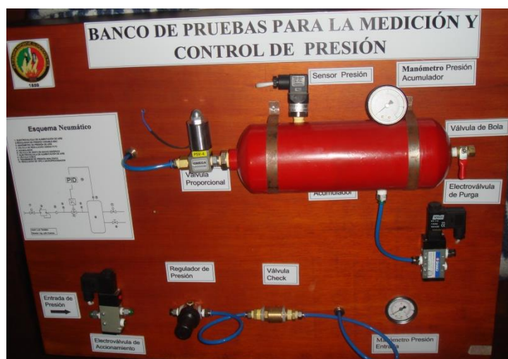
Figura 47. Prototipo con todos los elementos que permiten realizar el control de la presión.
