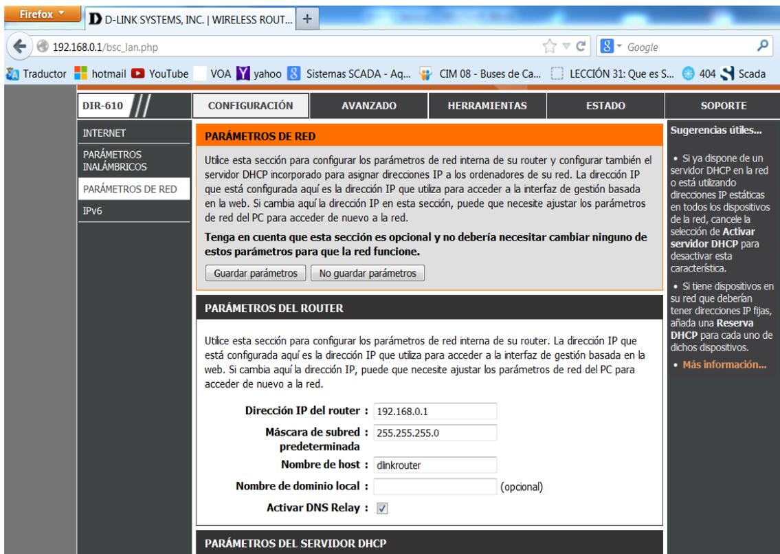
**Figura 31.** Asistente para configuración del módem D-Link
