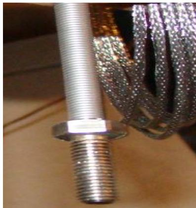
**Figura 15.** Sensor de temperatura tipo RTD
