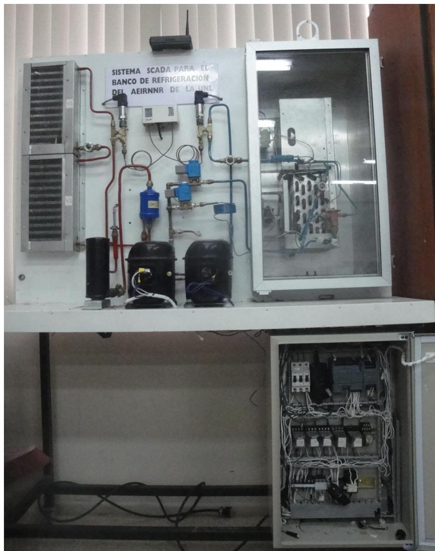
**Figura 23.** Banco de refrigeración con todos los elementos que permiten realizar el sistema SCADA
