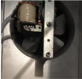
**Figura 11.** Ventilador del banco de refrigeración
