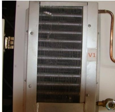
**Figura 9.** Condensador del banco de refrigeración
