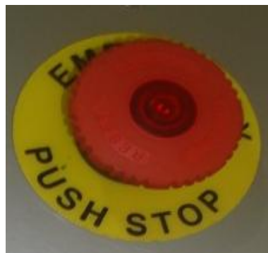
Figura 13. Pulsador de paro de emergencia
