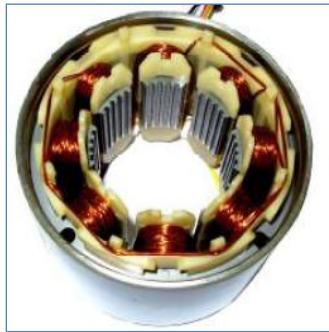
Figura 20. Aspecto constructivo del estator: 8 polos y vista de los dientes interiores de cada polo.
