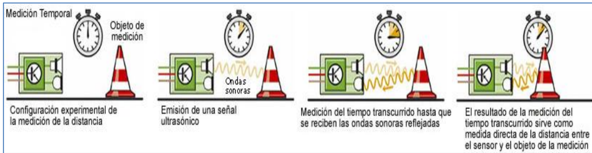
Figura 1. Funcionamiento de un sensor ultrasónico.
