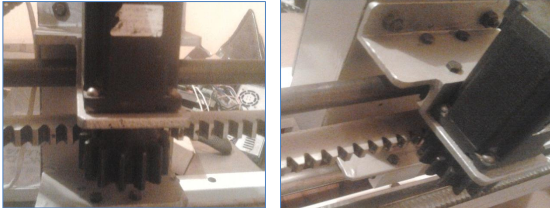
Figura 60. Trasmisión por piñón – cremallera.
