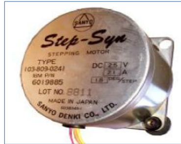
Figura 19. Aspecto exterior de un motor PaP. Se aprecian la placa de características y los seis conductores de salida (motor unipolar). Fuente: (CARLETTI, 2009)
