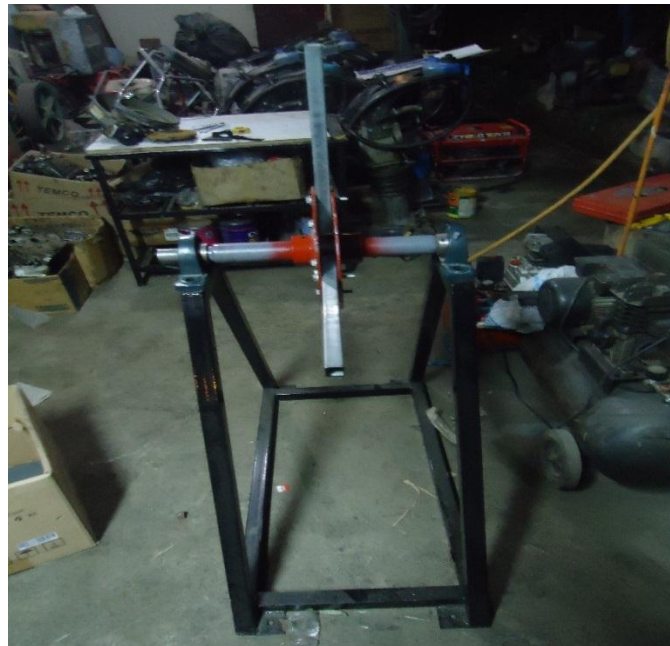
Imagen. 8. Ensamblaje de árbol, chumaceras y base de soporte de rueda hidráulica
