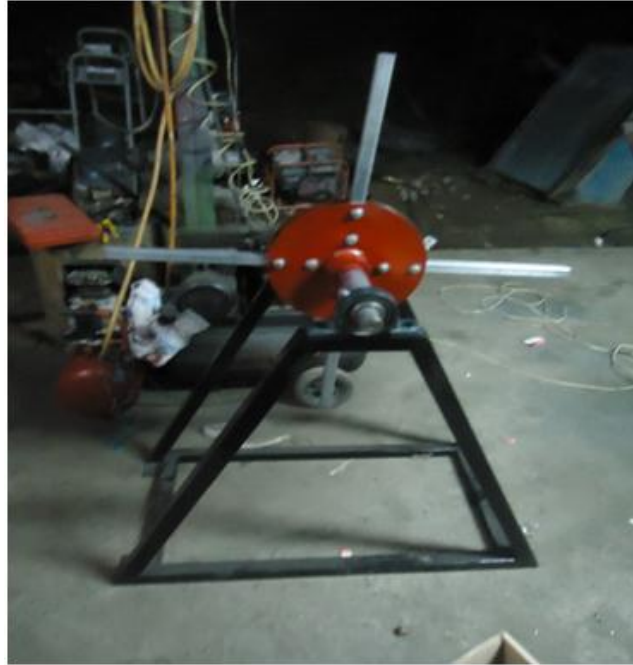
Imagen. 7. Ensamblaje de rayos y manzana de transmisión de potencia
