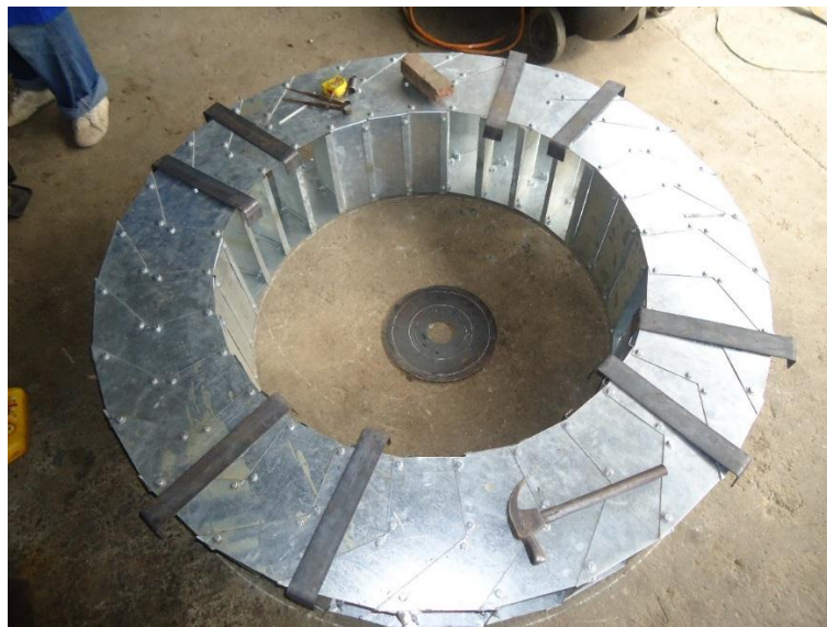
Imagen. 4. Ensamblaje de canjilones de rueda hidráulica
