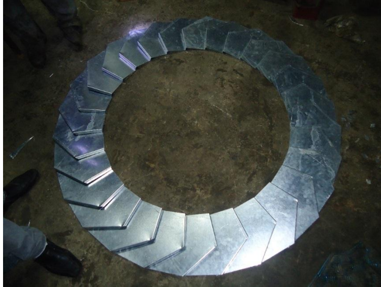
Imagen. 3. Tapas laterales de canjilones terminadas
