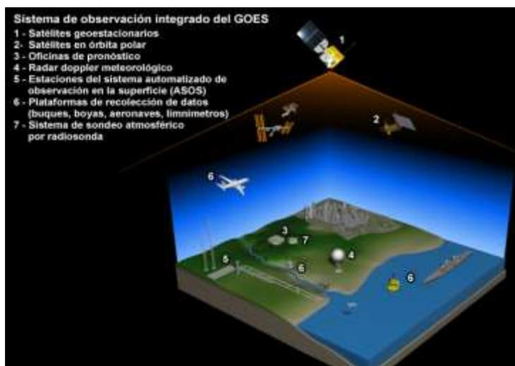
**Figura 7.-** Los satélites ambientales y los distintos sistemas de observación terrestres y atmosféricos que comprenden el sistema integrado de observación GOES.
