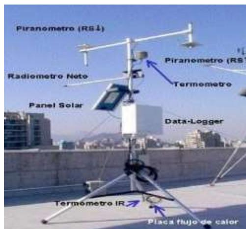
**Figura 6.-** Partes básicas de una Estación.
