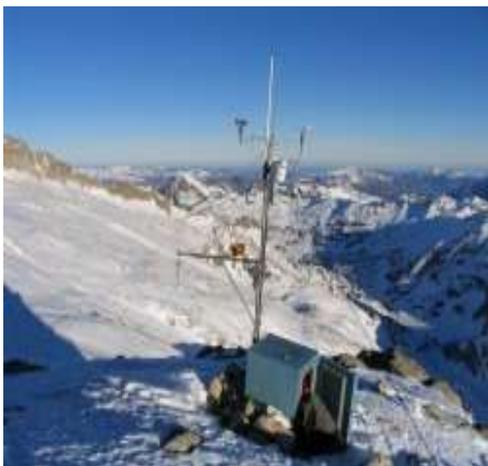
**Figura 5.-** Estación Meteorológica.
