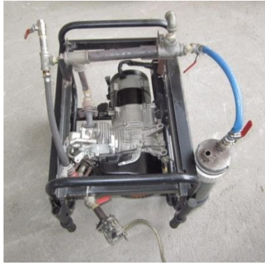
Fig. 19: Segundo sistema Pantone acoplado al grupo electrógeno.
