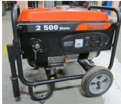
Fig. 13: Grupo electrógeno de 2500 watts.
