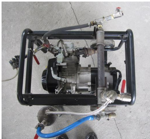
Fig. 17: Primer sistema Pantone acoplado al grupo electrógeno.
