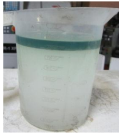
Fig. 23: Gasolina y agua residuales después del funcionamiento del segundo sistema.
