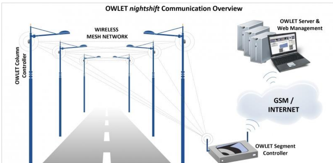
Figura 42. Arquitectura del sistema de Telegestión Owlet
