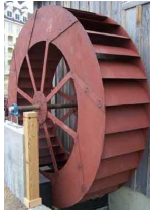
Fig. 2 Rueda hidráulica de alimentación inferior de álabes curvos.
