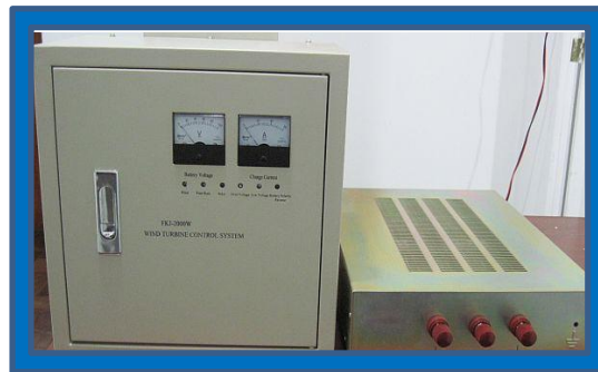
Figura 4.6: Controlador de carga EXMORK
