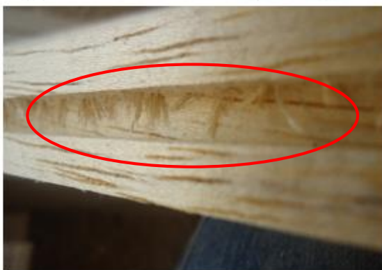
Figura 1c. Grano levantado (Viruta III)
