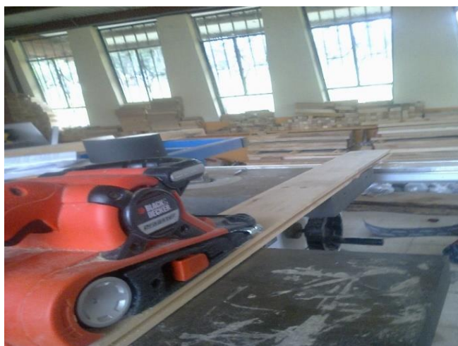
Figura 14. Ensayo de Lijado de cuatro especie forestales
