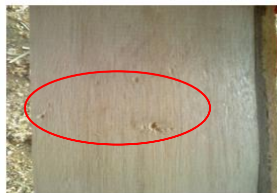
Figura 1d. Marcas de Viruta
