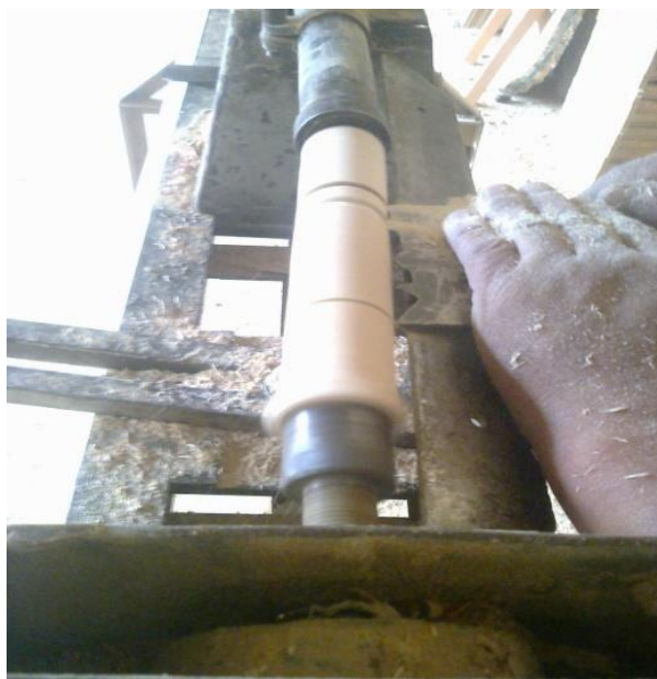
Figura 15. Ensayo de torneado de cuatro especies forestales del Sur de la Amazonia
