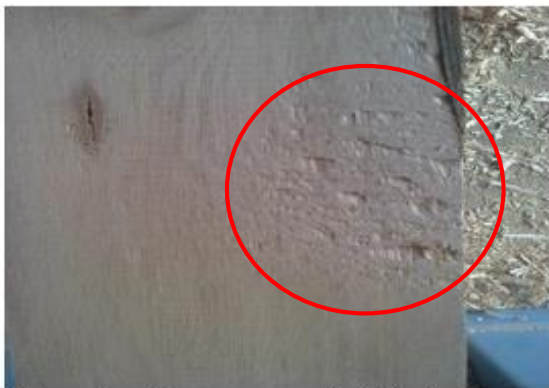
Figura 1a. Grano arrancado (Viruta I)
