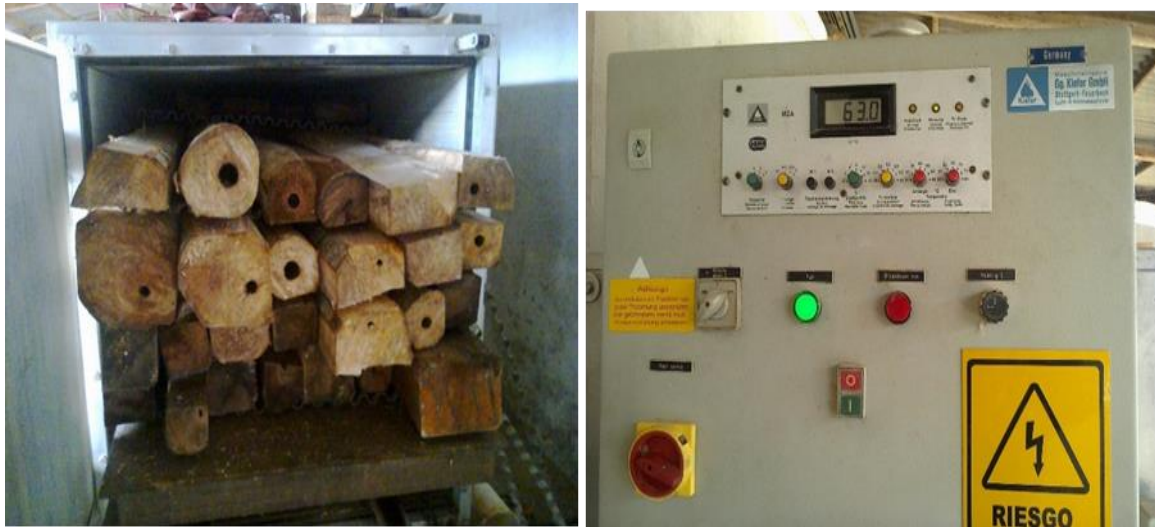
Figura 7. Secado de madera al 12 % de contenido de humedad
