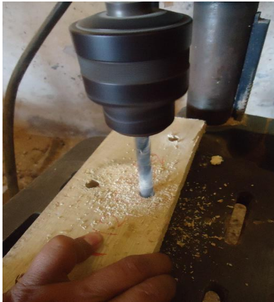
Figura 13. Ensayo de Taladrado en cuatro especies maderables del Sur de la Amazonía
