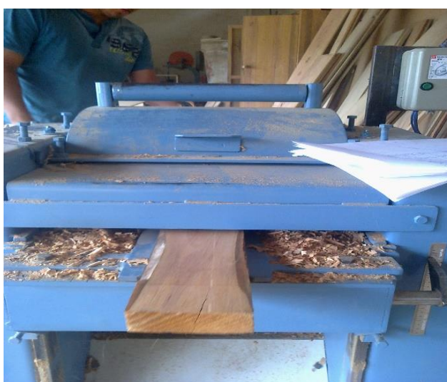
Figura 10. Ensayo de cepillado de las cuatro especies maderables
