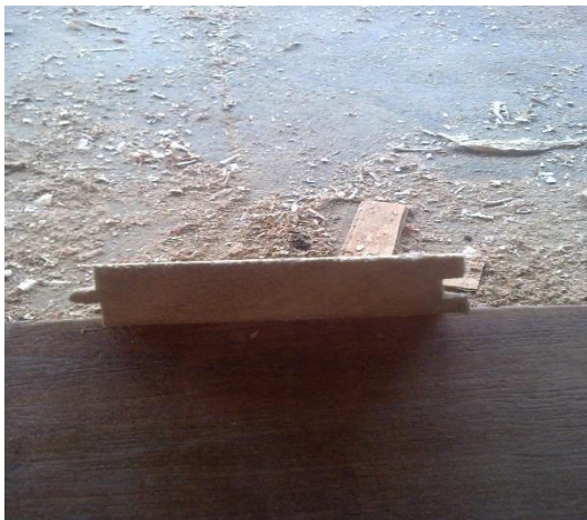
Figura 11. Ensayo de moldurado para cuatro especies maderables de bosque secundario
