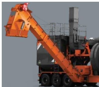
Figura 11: Elevador de la Mezcla Asfáltica
