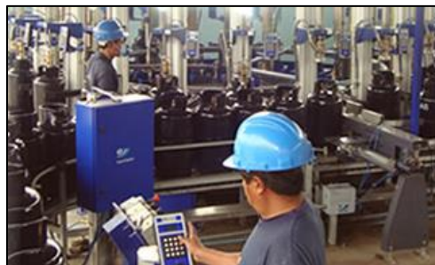
FIGURA 3: Control de peso de los cilindros de 15 kg.
