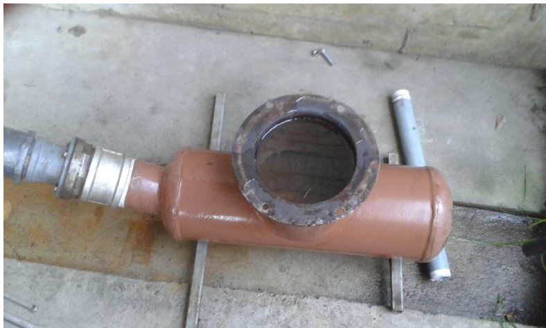
Fotografía 1: Tubo de alimentación, Acople de ampliación, Tapa lateral izquierda, Tapa lateral derecha, Cilindro horizontal, brida inferior. (De izquierda a derecha)
