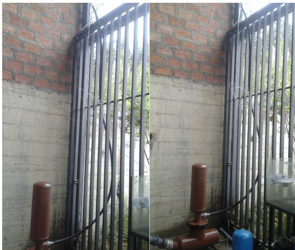
Fotografías 10 y 11 : Ariete Hidráulico Multipulsor con Válvulas en Disposición Circular en funcionamiento.
