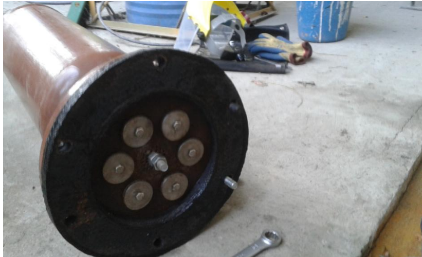
Fotografía 3: Brida superior, Empaque, Válvulas en disposición circular, válvula central, Cámara de aire.
