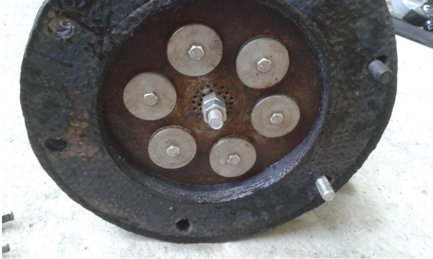
Fotografía 2 : Brida superior, Empaque, Válvulas en disposición circular, válvula central.
