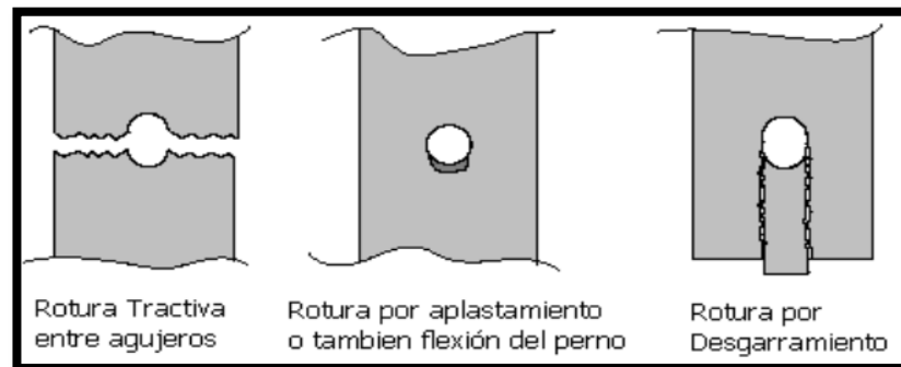
Fig. 17: Tipos de falla característicos en una unión por pernos.
