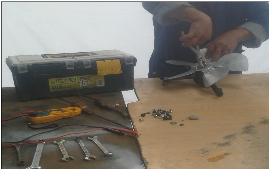
Foto 02: Instalando el aspa al motor ventilador.
