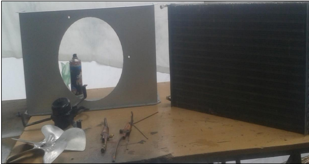
Foto 01: Vista de los elementos que conforman un condensador por aire forzado.
