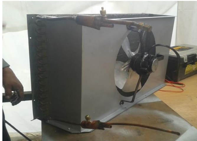
Fig. 37: Foto del condensador por aire forzado a instalarse
