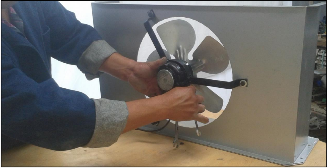
Foto 03: Ensamblando el motor ventilador a la carcasa del condensador.
