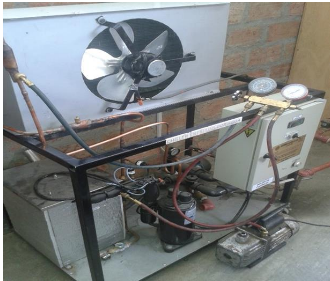
Fig. 40: Foto de realización del vacío al sistema
