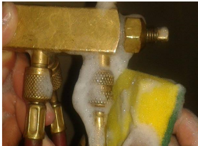
Fig. 39: Fotos de verificación de puntos de fuga Fuente: Autor
