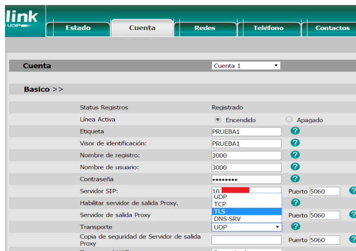
Ilustración 82: Configuración de (TLS) en el teléfono Yealink.
