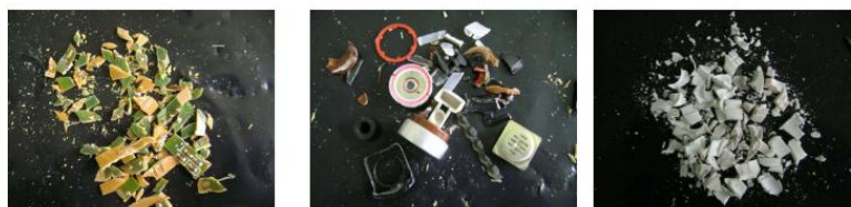
Figura 12 Desensamble Mecánico de RAEE [Martínez, 2010]
