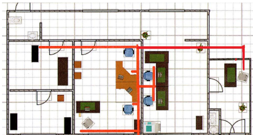
Figura 12. Estructura de la red Telefónica
