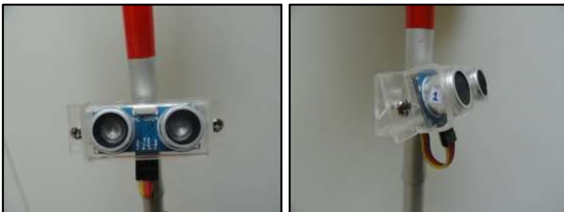
Figura 36. Piezas de acrílico para acoplamiento de sensores. Fuente [El Autor].
