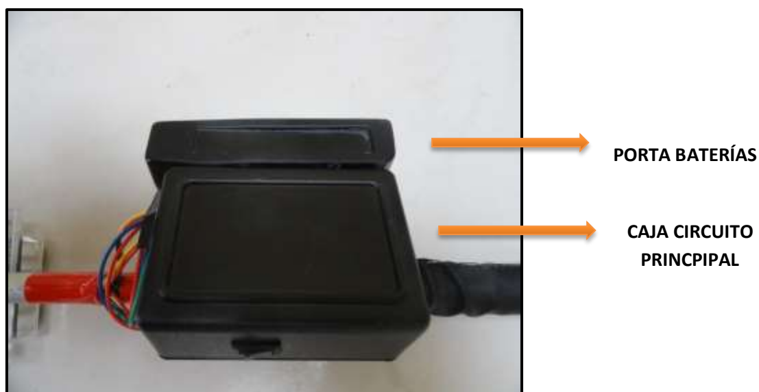
Figura 33. Caja con el circuito principal del sistema junto con el porta baterías. Fuente [El Autor].
