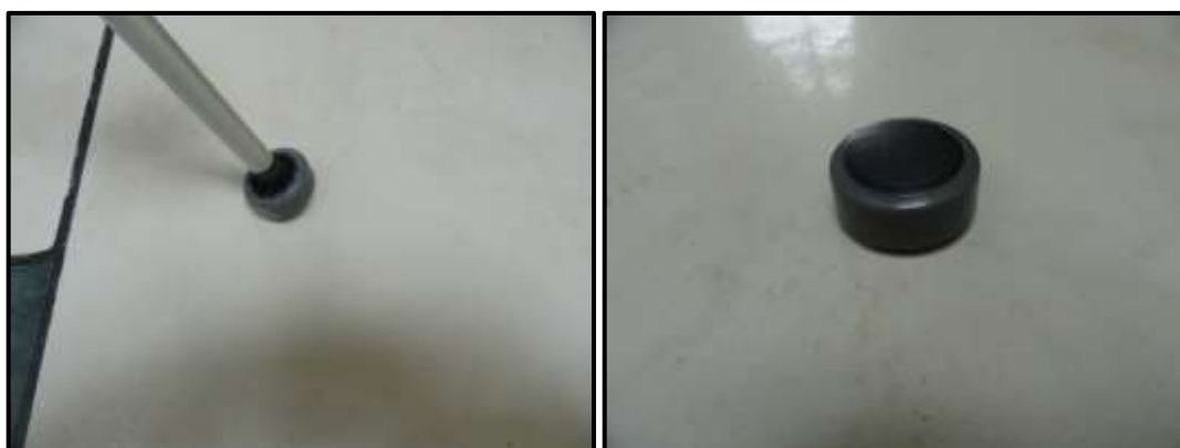
Figura 35. Llanta giratoria acoplada al bastón. Fuente [El Autor].
