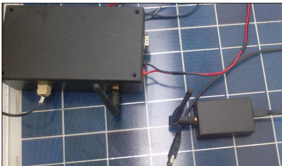
Figura 37. Transceptor que se ubica en el módulo caracterizador y transceptor que se conecta al ordenador del usuario.
