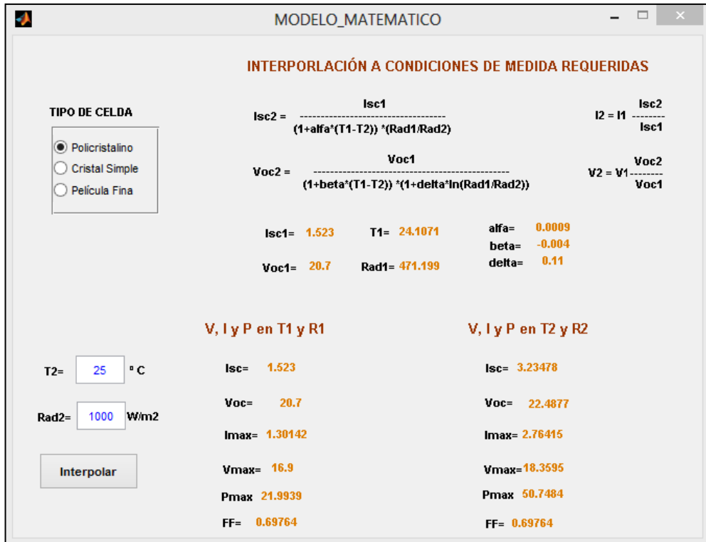
Figura 42. Ventana que indica los resultados de la caracterización del panel fotovoltaico de 50 Vatios en las condiciones STC.
