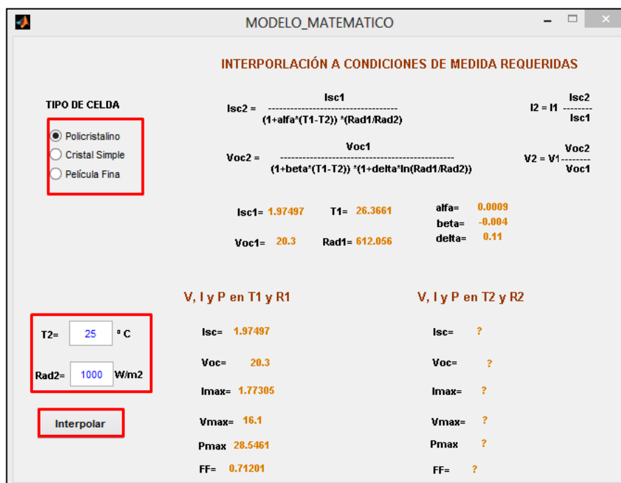
Figura 58. Ventana que permite la interpolación de las curvas I-V a las condiciones de Temperatura y Radiación solar que se requiera (T2 y Rad2).
