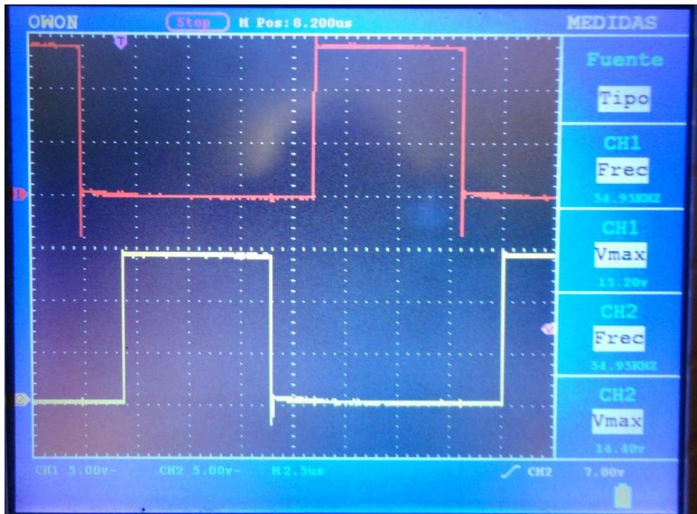
Figura 53 Señal de control para los IGBTs obtenida desde el driver IR2110
