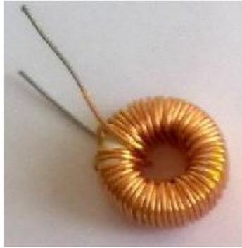
Figura 24 Inductor para el filtro de armónicos
