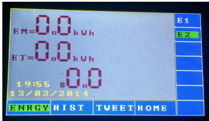
Fig. C.6. Pantalla de presentación del submenú “E2” Energía mensual, energía total, y costo de energía mensual.
