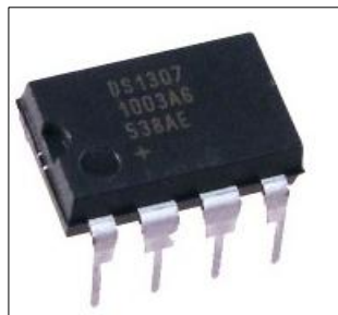
Figura 12. Circuito integrado del RTC. DS1307. Fuente: [El Autor].
