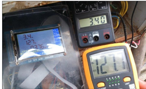
Figura 38. Medición de corriente y voltaje con el prototipo y los instrumentos de medición respectivos. Fuente: [El Autor].
