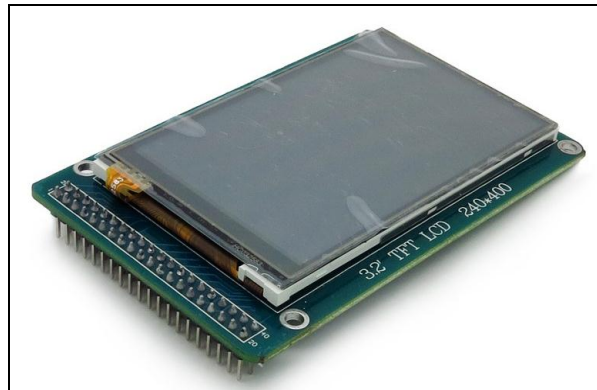
Figura 19. Pantalla Táctil “TFT-LCD”. Fuente: [23].
