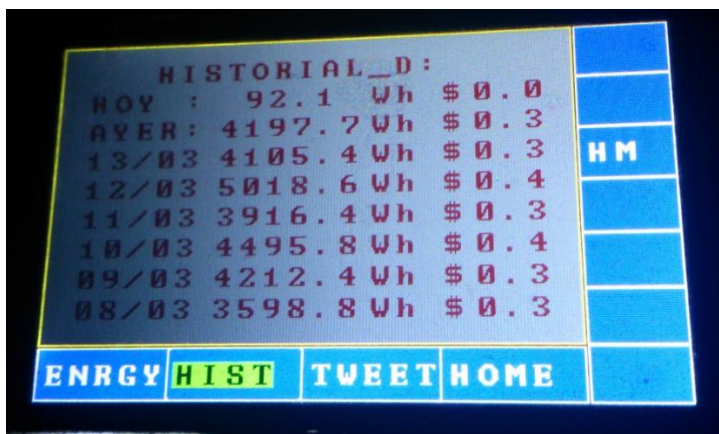
Fig. C.7. Pantalla de presentación del menú “HIST”, historial de energía diaria consumida, con fecha y el respectivo costo.
