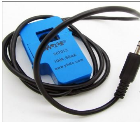
Figura 11. Yhdc transformador de corriente: sct-013-000. Fuente: [El Autor].
