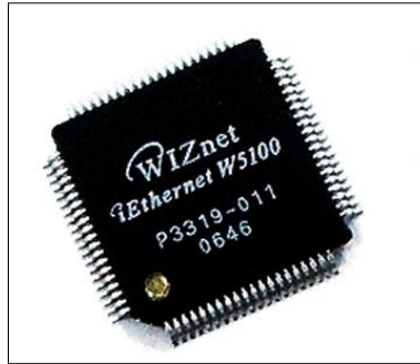
Figura 20. Circuito Integrado Wiznet W5100. Fuente: [24].
