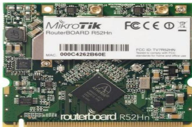
Figura 56. MiniPCI Mikrotik R52Hn. [26]
