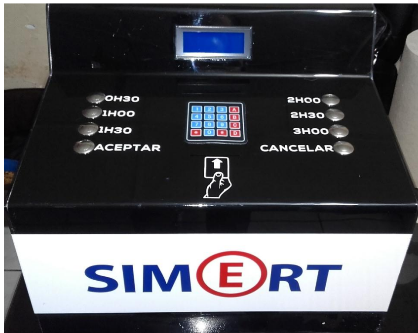
Figura 36. Dispositivo de control finalizado
