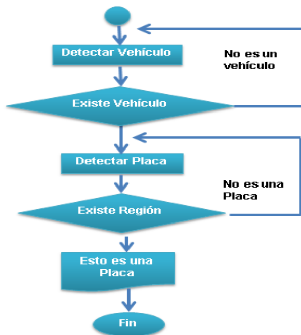
Figura 55: Diagrama de flujo del algoritmo para la detección de matrículas vehiculares.
