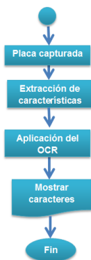
Figura 4. Diagrama de flujo del algoritmo empleado para el Reconocimiento Óptico de Caracteres.
