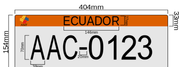
Figura 54: Placa de un vehículo con sus medidas correspondientes.
