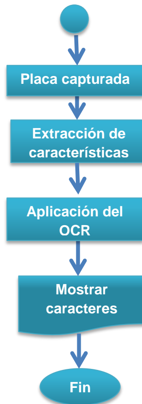
Figura 56: Diagrama de flujo del Reconocimiento Óptico de caracteres de las Placas vehiculares.
