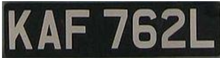
Figura 51: Los primeros sistemas ANPR eran incapaces de leer letras blancas o plateadas sobre un fondo negro.
