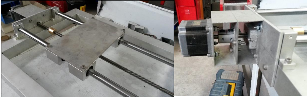
Montaje del Eje Y
