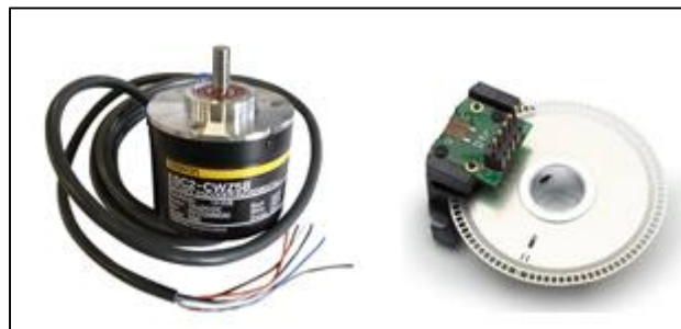
Figura 14. Estructura externa e interna de un Encoder. [26]
