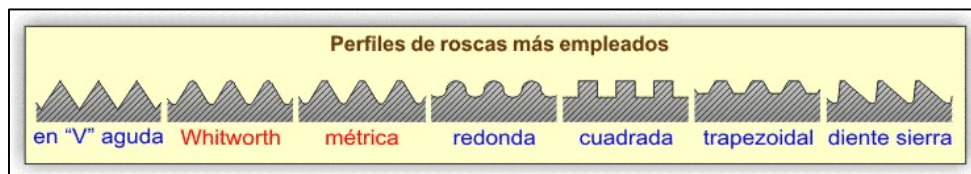
Figura 9. Tipos de roscas de husillos empleados en máquinas CNC. [21]
