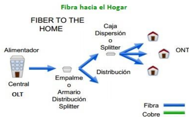
Figura 22 Arquitectura Fibra hacia el Hogar, Fuente [6]
