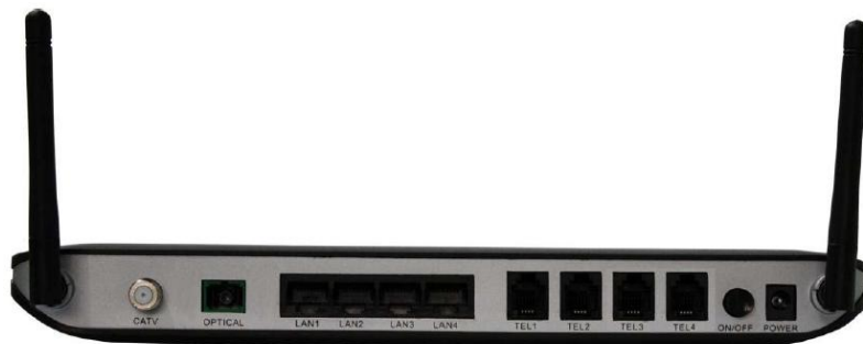
Fig. 41: Puertos y botones en el panel trasero de la HG8447
